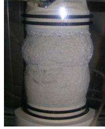
Şekil 3. Tek Sıra Donatılı Kum Zeminlerin Kırılma Şekli
