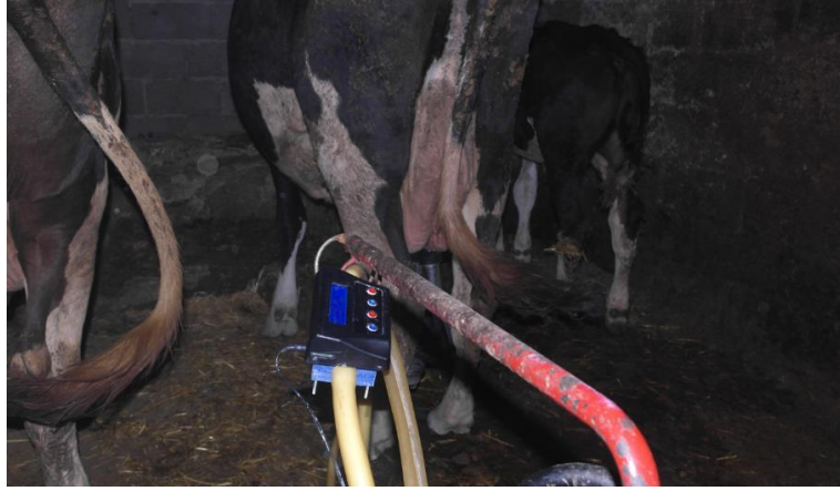
Şekil 5.15: Ölçü aletinin gerçek bir sağım hayvanında test edilmesi.
