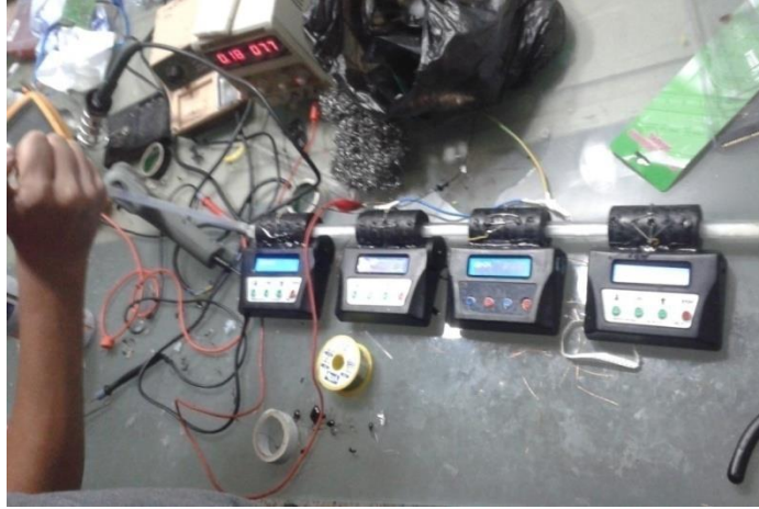
Şekil 5.22: Ölçü aleti kalibrasyon çalışması.
