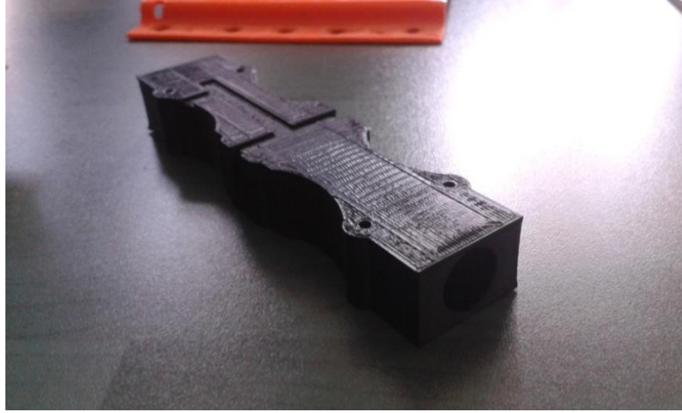
Şekil 5.25: 3D Yazıcıda üretilen sıkı geçme kalıp.
