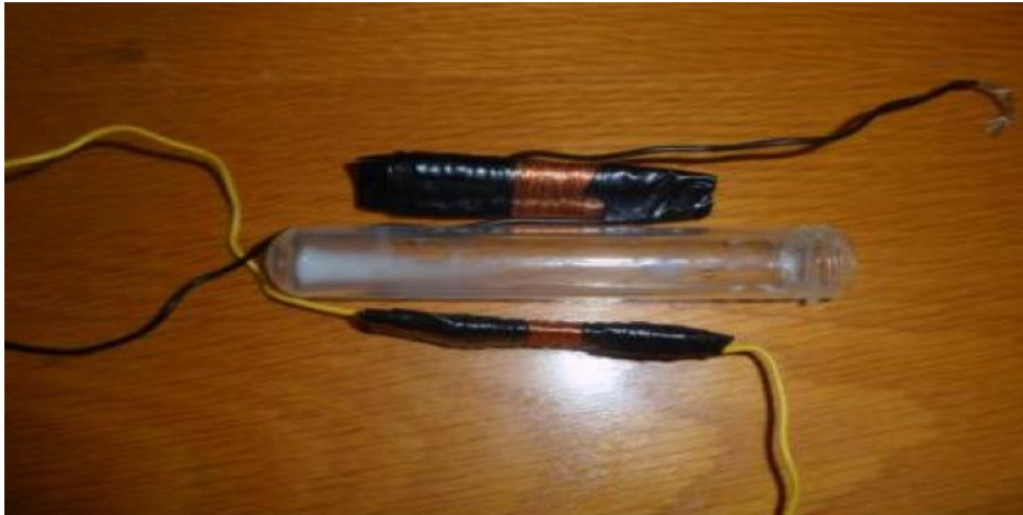
Şekil 3.12: Elektromanyetik akış ölçer için yapılan deney düzeneği.
