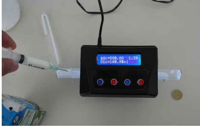
Şekil 5.12: Ölçü Aletinin laboratuvar ortamında yapılan miktar ölçüm testleri.
