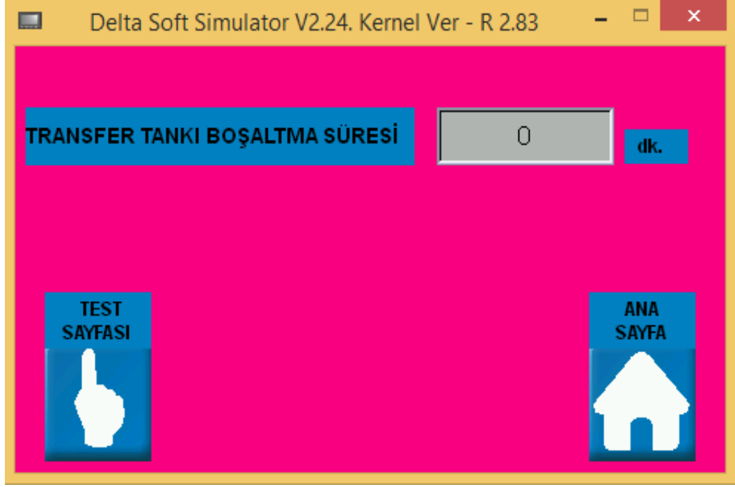
Şekil 5.35: Yıkama modu transfer kazanı boşaltma süresinin ayarlanması.
