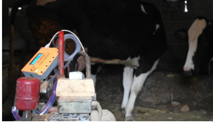
Şekil 5.20: Kalibre edilen ölçü aletinin sağım hayvanında denenmesi.
