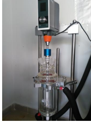
Şekil 2.2: Manyetik nanoparçacıkları sentezlemek için kullanılan reaktör sistemi.
