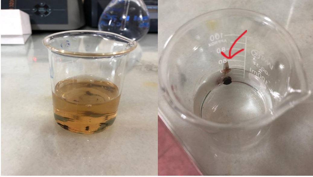
Şekil 2.1: Adsorpsiyon çalışmalarında manyetit nanoparçacıklarının mıknatıs tarafından toplanması.
