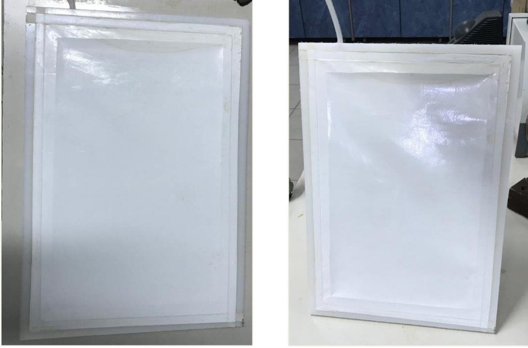
Şekil 3.4: MBR Sisteminde Kullanılan Çift Taraflı Membran Kasetleri
