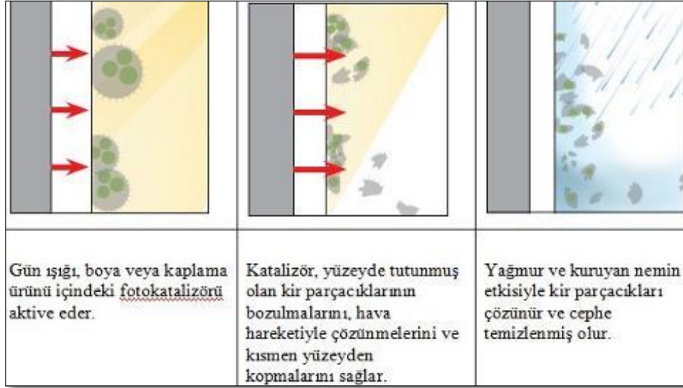
Şekil 2.5: Gün ışığının etkisi ile kendi kendini temizleyen cephe (url-7).
