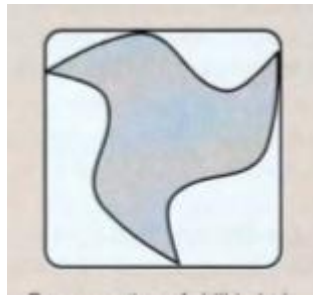
Şekil 1.2: Harry Watts'ın kesici takımının kare içindeki görünümü.
