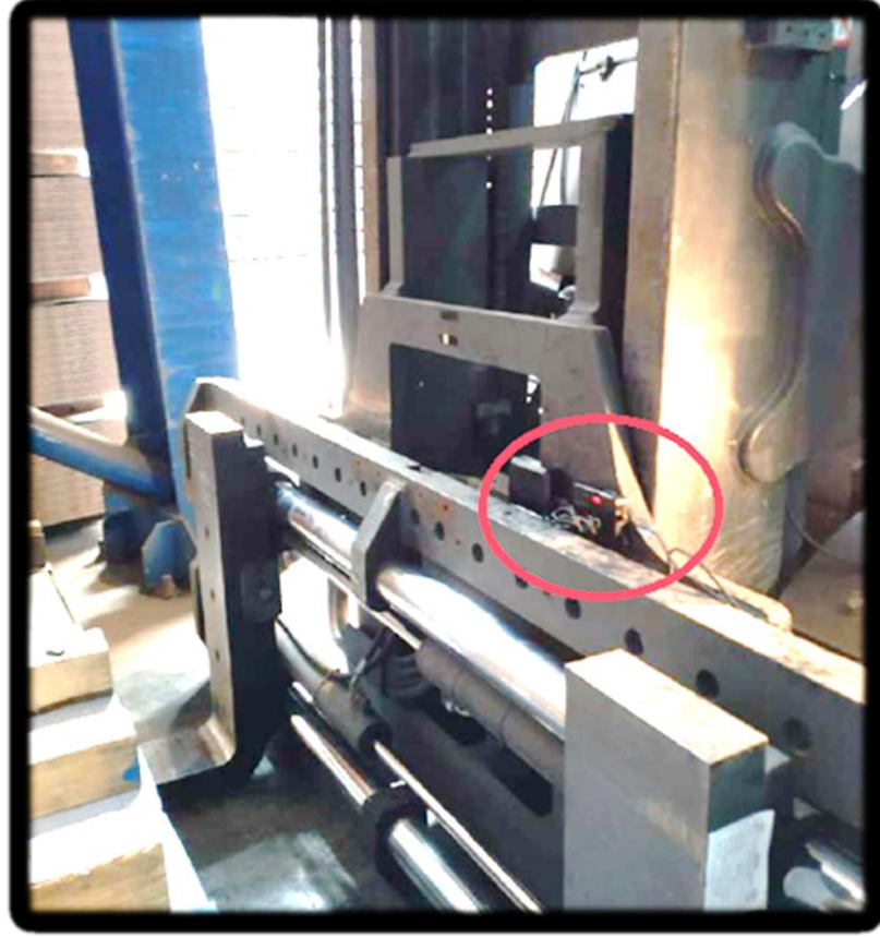
Şekil 5.8: RFID okuyucu tagların forklifte uygulanışı.
