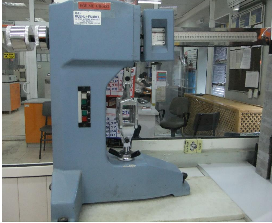
Şekil 3.7: Eğilmede çekme dayanım cihazı.
