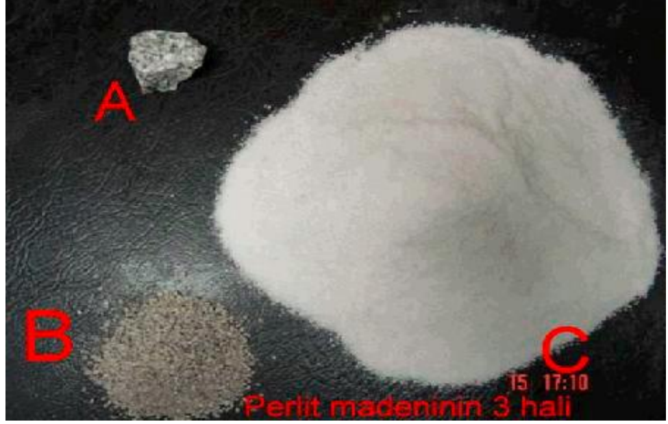
Şekil 2.1: Kayaç haldeki perlit (a), ham perlit (b) ve genişletilmiş perlitin (c) görünümü [7].
