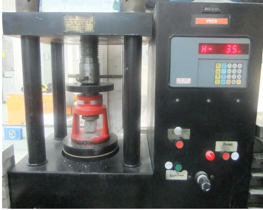
Şekil 3.8: Basınç dayanım cihazı.
