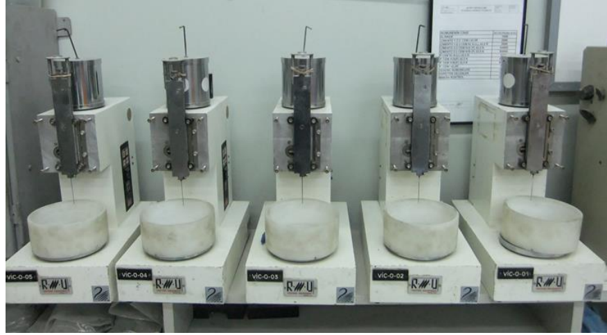
Şekil 3.3: Otomatik vicat cihazı.
