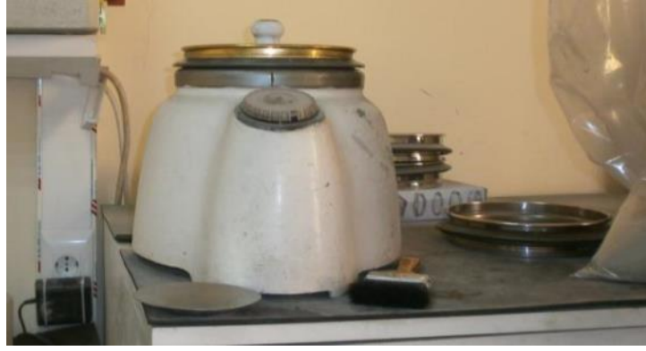
Şekil 3.2: Alpine marka incelik ölçüm cihazı.
