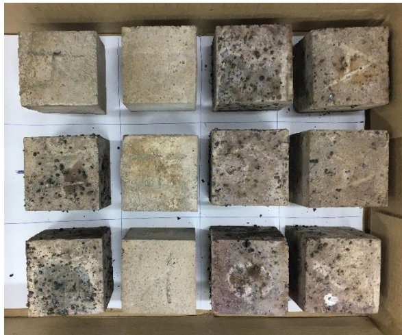
Şekil 6.14: 400 °C’de yüksek sıcaklığa maruz kalan numuneler.
