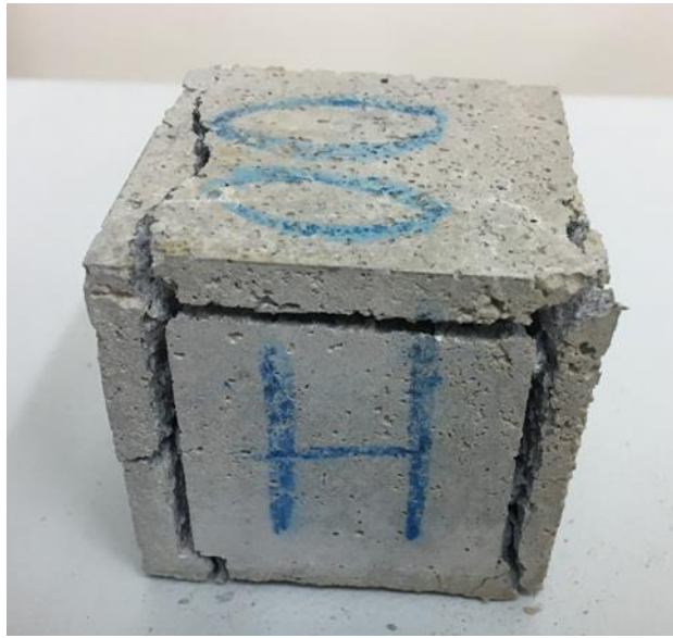
Şekil 6.15: 200 °C’ de yüksek sıcaklığa maruz kalıp, basınç dayanımı deneyi uygulanan KU numunesi.
