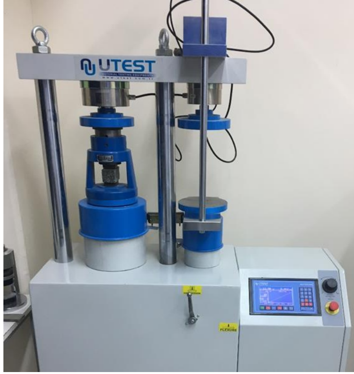
Şekil 5.4: Basınç dayanımı deney düzeneği.
