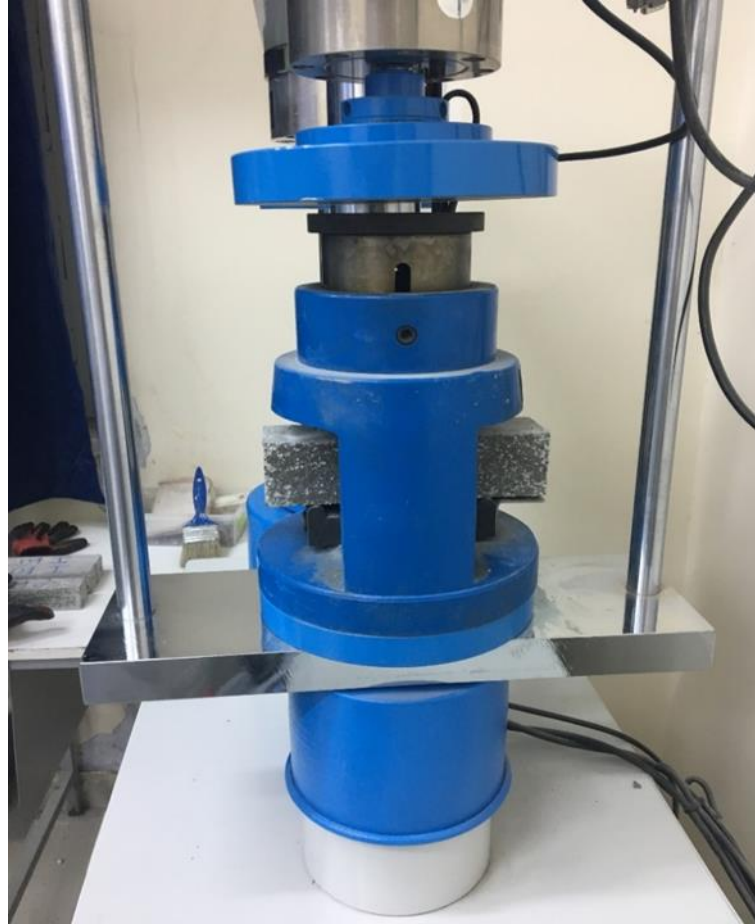
Şekil 5.3: Eğilmede çekme dayanımı deney düzeneği.
