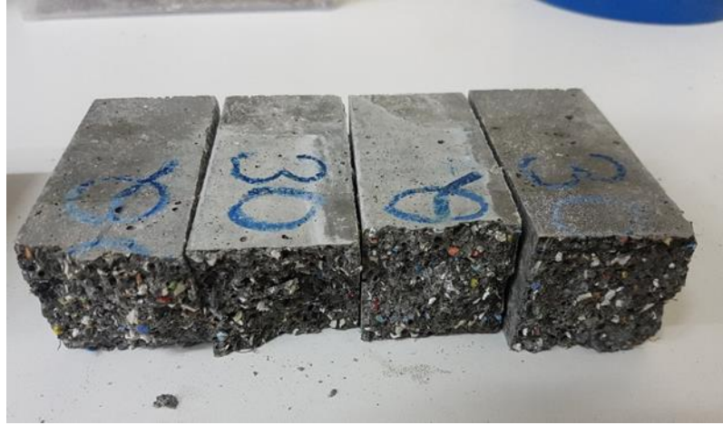
Şekil 6.7: Basınç dayanımı sonrası numune görselleri.
