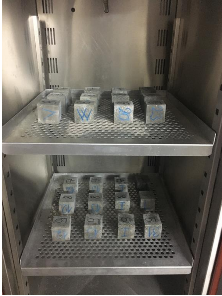
Şekil 5.6: Donma-çözülme deneyi test cihazı.
