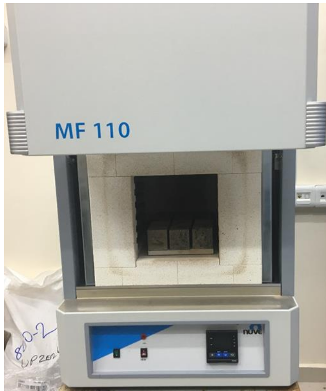
Şekil 5.5: Yüksek sıcaklık deneyi kül fırını.
