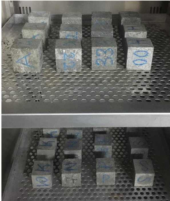
Şekil 6.18: Donma-Çözülme deneyi sonrası küp numuneler.
