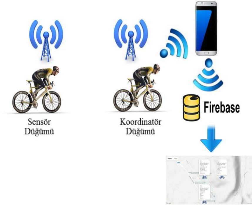
Şekil 3.31: Sensör verilerinin internet sayfasına aktarılmasını gösteren blok diyagramı.
