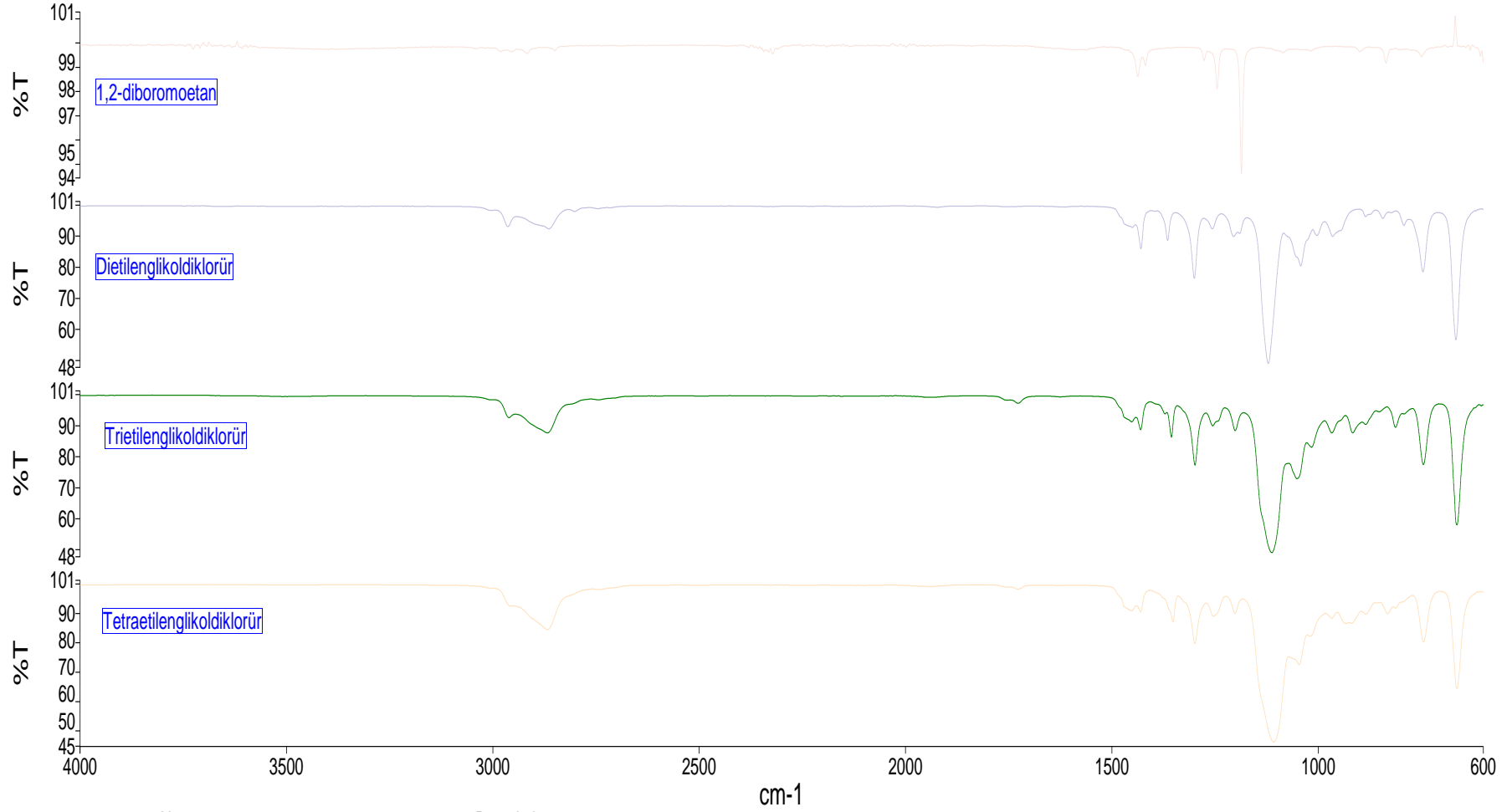
Şekil 4.2: Reaksiyonlarda kullanılan mono, di, tri, tetraetilen glikol diklorür/bromürlerin FT-IR spektrumu.
