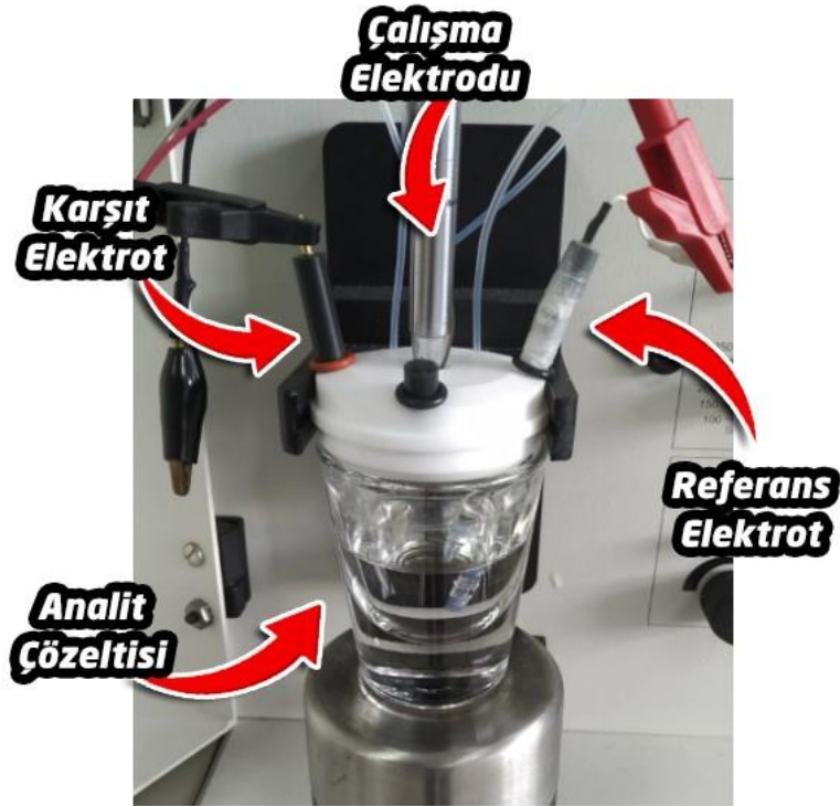
Şekil 1.5: Çalışmalarda kullanılan hücre ve üçlü elektrot sistemi.
