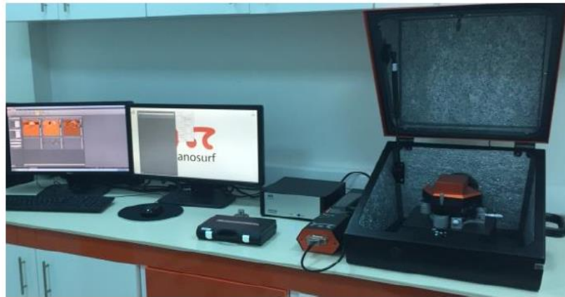
Şekil 2.8: Nanosurf Easy Scan 2 AFM cihazı
