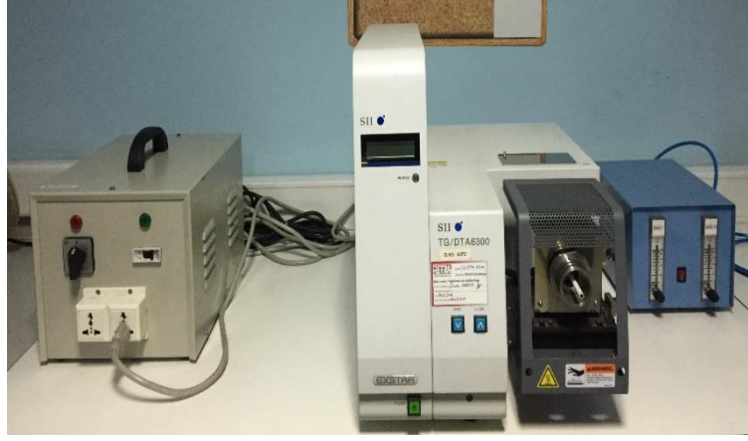
Şekil 2.4: TG/DTA 6300 termogravimetrik analiz cihazı
