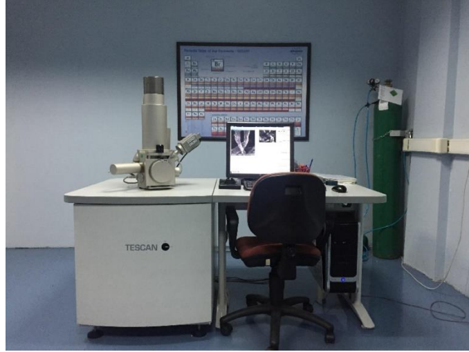
Şekil 2.7: TESCAN marka SEM
