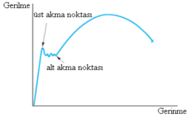
Şekil 1.17: Gerilme-Çekme gerilme grafiğinde akma noktalarının gösterimi
