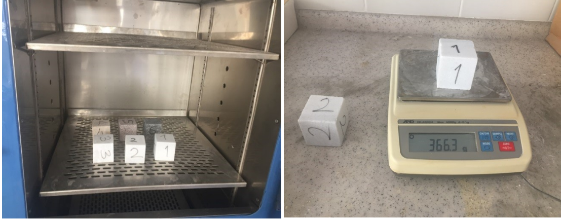
Şekil 5.41: Taş numunelerin 105°C’de kurutulduktan sonraki durumu ve tartılması.
