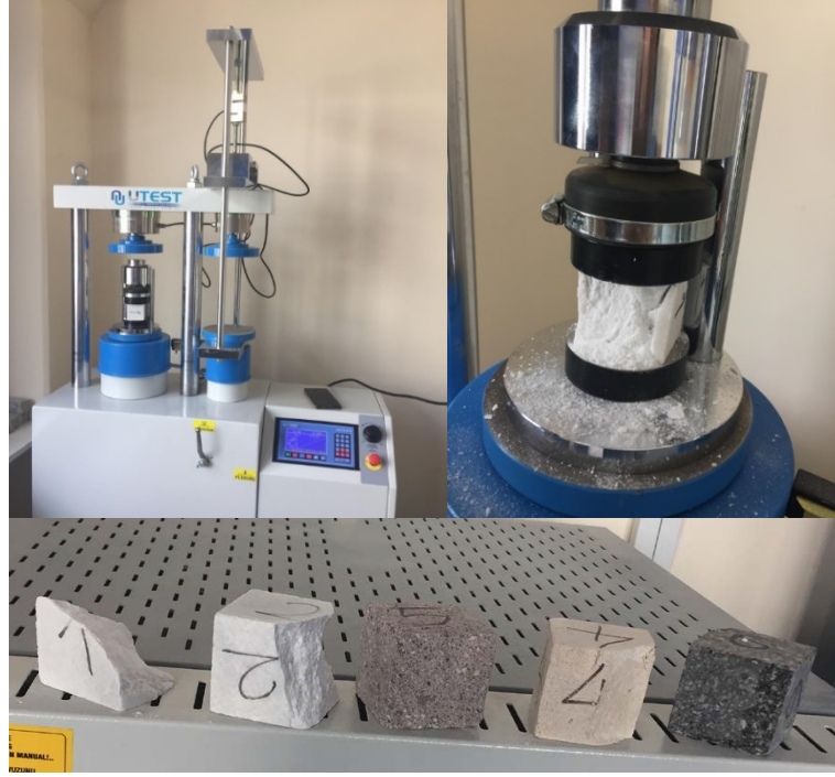
Şekil 5.45: Tek eksenli basınç dayanımı deneyinin uygulama aşamaları.
