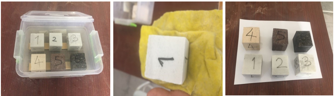
Şekil 5.43: Taş numunelerinin toplam su emme deneyinin uygulama aşamaları.
