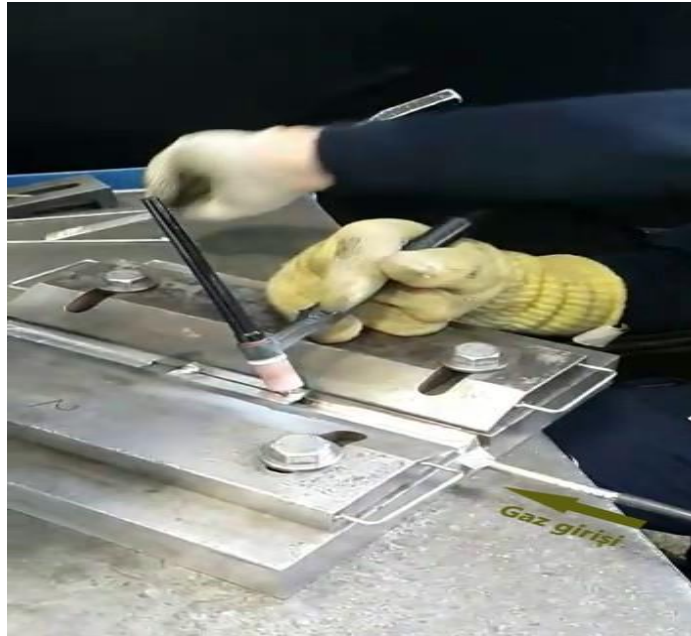
Şekil 5.3: Deneyde kullanılan kök koruyucu altlık.
