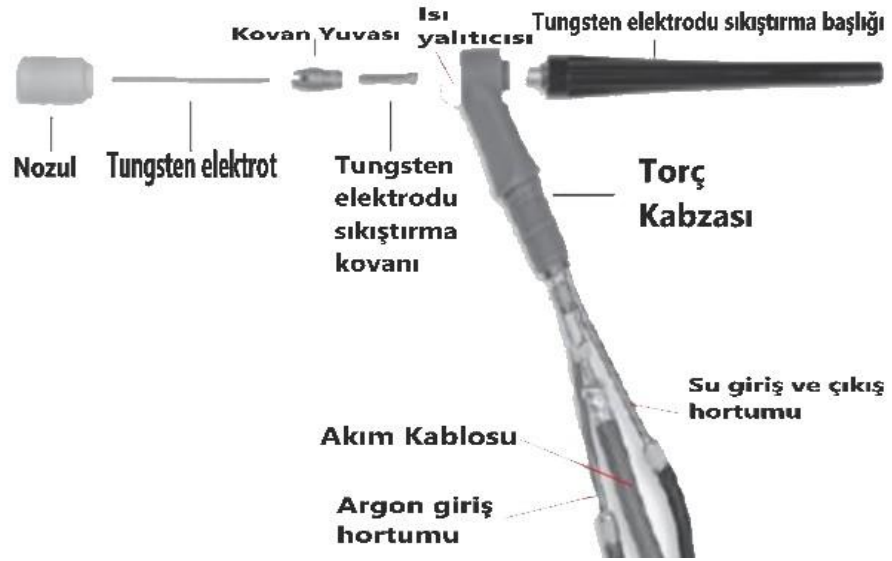
Şekil 4.3: TIG kaynak torcu ve elemanları.
