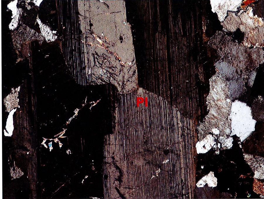
Şekil 3.15: HA16: Göloba plütonuna ait kayalara ait ince kesitlerde görülen albit ikizlenmesi gösteren kırıklı, hafif altere olmuş plajiyoklaz mineralinin görünümü (çift nikol, x4).
