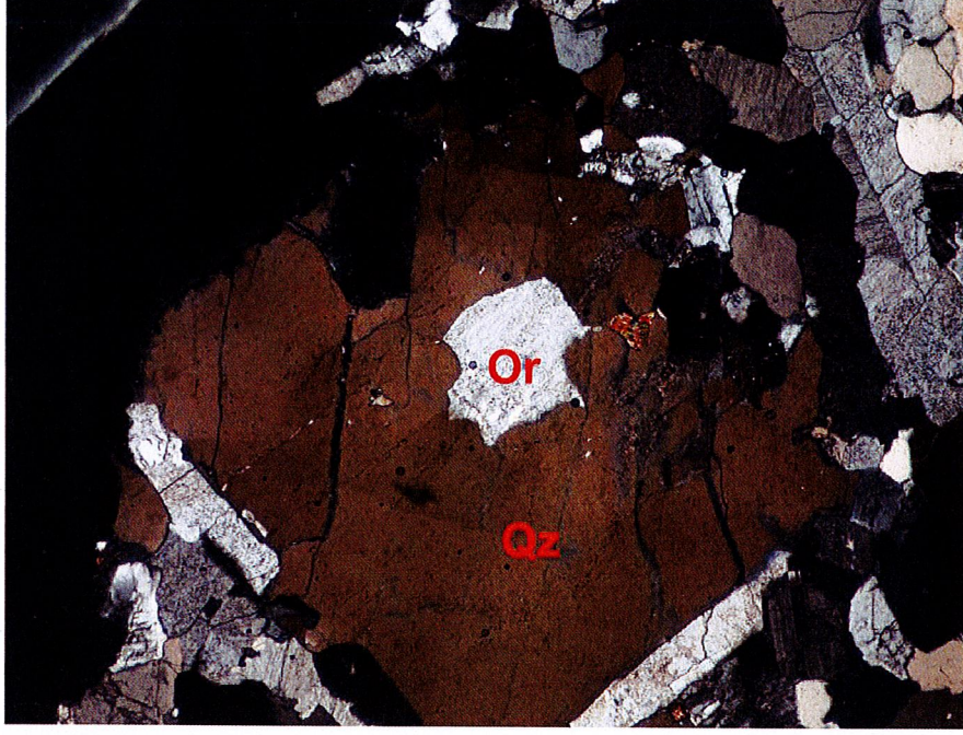
Şekil 3.23: HA4: Göloba plütonuna ait kayalara ait ince kesitlerde görülen kuvars içerisindeki ortoklaz mineralinin görünümü (çift nikol, x4).
