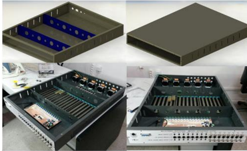
Şekil 3.28: Tasarlanarak üretilen kasa görünümü.
