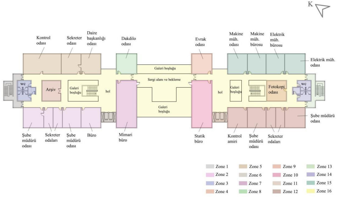
Şekil C.3: Rektörlük binası 2. kat planı ve ısıl bölgeleme.
