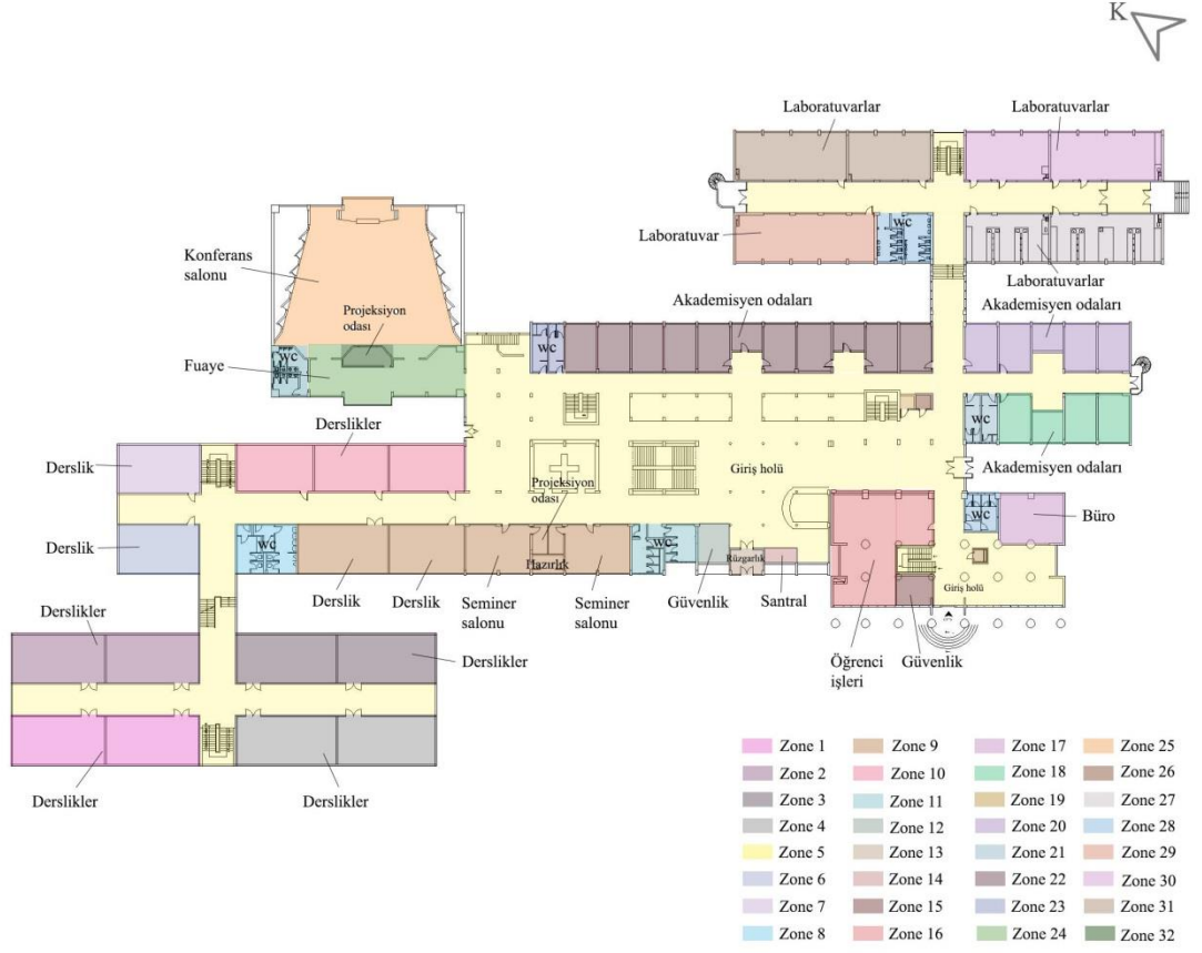
Şekil 3.29: F.E.F zemin kat planı ve ısıl bölgeleme.
