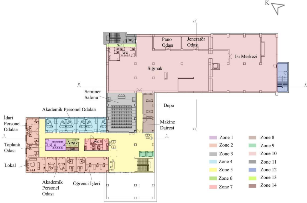
Şekil D.1: B.E.S.Y.O binası bodrum kat planı ve ısıl bölgeleme.
