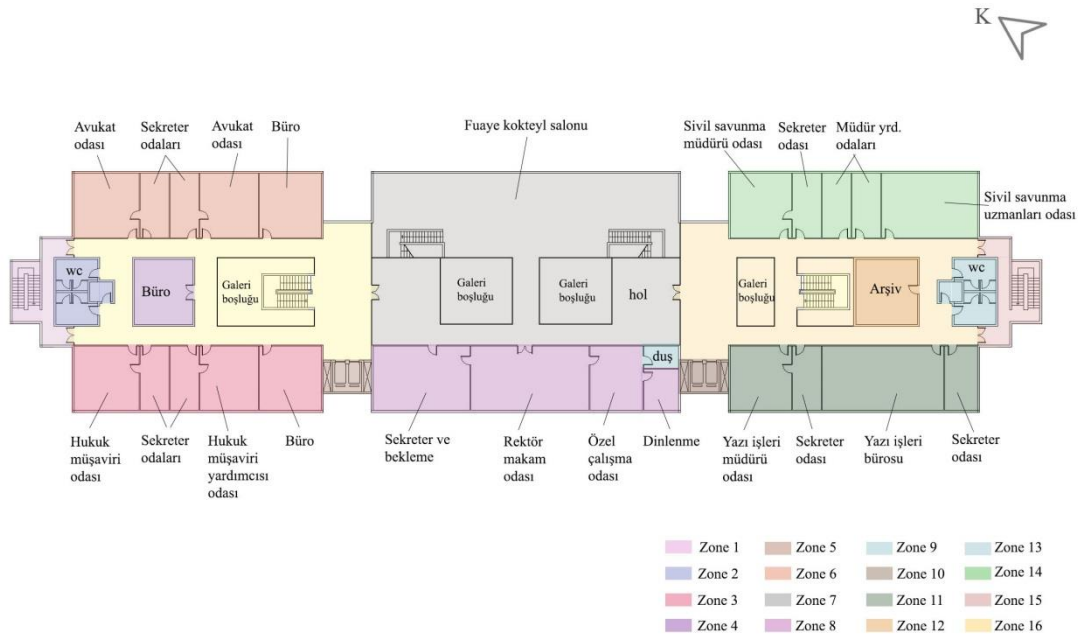
Şekil C.6: Rektörlük binası 5.kat planı ve ısı bölgeleme.
