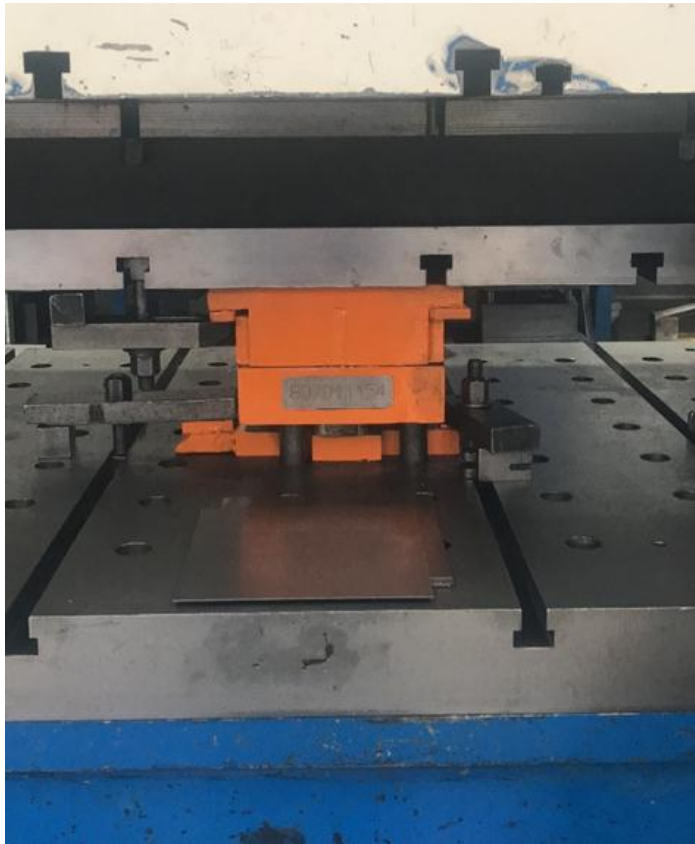
Şekil 6.2: Kalıbın prese bağlanması.
