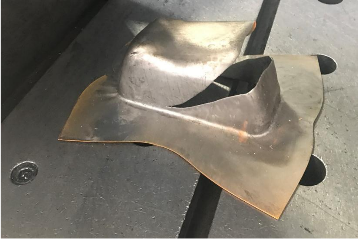
Şekil 6.4: DC03 malzeme üretim sonucu.
