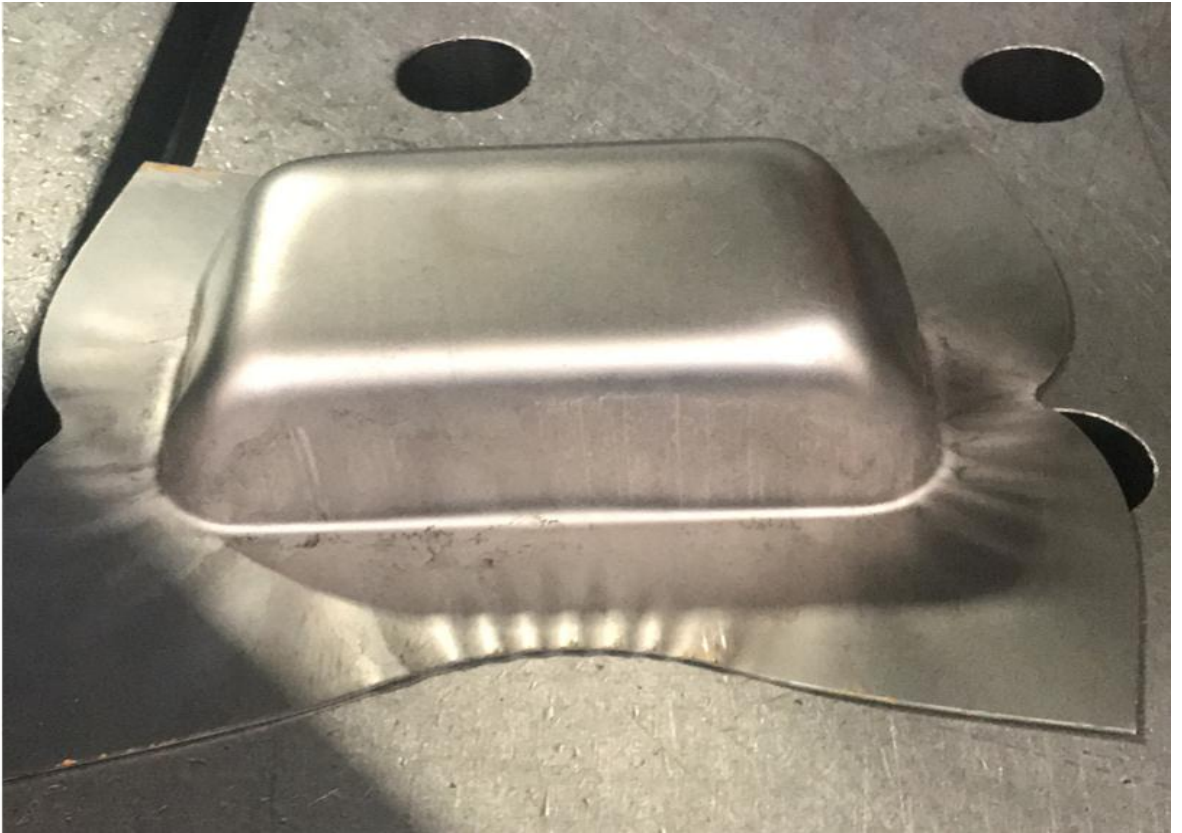
Şekil 6.5: DC05 malzeme üretim sonucu.
