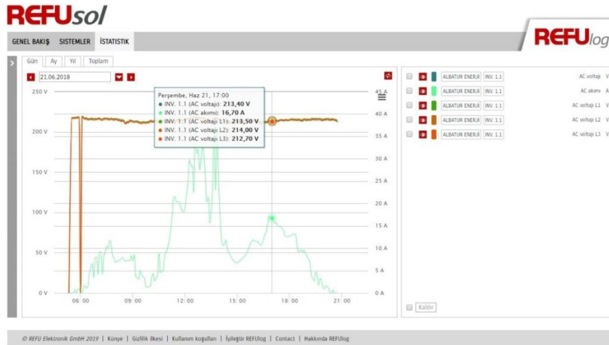
Şekil 4.19 b: 40 kW'lık REFUsol eviricinin ekran görüntüsü (AC akım ve gerilim)
