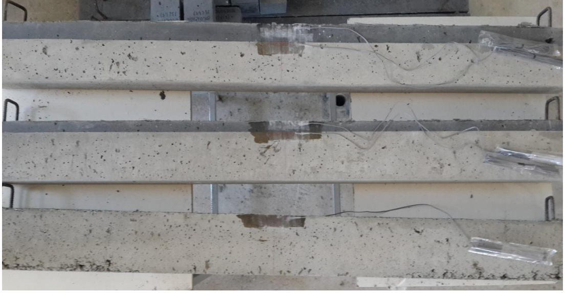
Şekil 2.14: Test kirişlerindeki şekildeğiştirme ölçer (strain gauge) yerleşimleri.
