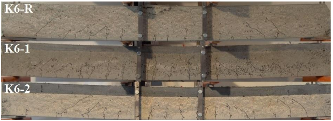
Şekil 2.38: K6 ( \rho=0.0507 ) kirişlerine ait çatlak dağılımları ( L/70 yerdeğiřtirmesi).
