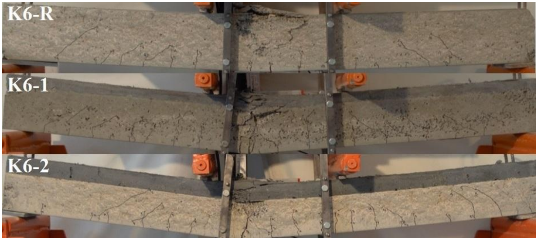
Şekil 2.39: K6 ( \rho=0.0507 ) kirişlerinde kırılma (göçme) durumuna ait çatlak dağılımları.
