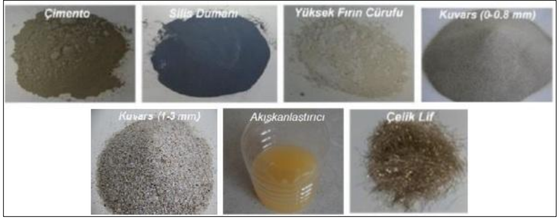
Şekil 2.2: UYPLB'yi oluşturan bileşenler (Ayrıca su kullanılmıştır).
