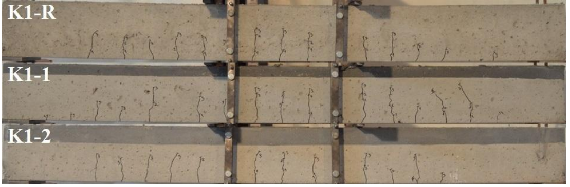
Şekil 2.22: K1 ( \rho=0.0122 ) kirişlerine ait çatlak dağılımları ( L/250 yerdeğiřtirmesi).
