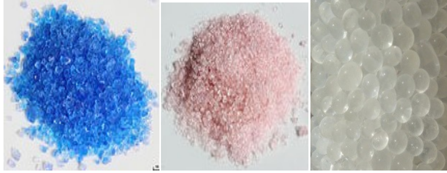
Şekil 1.2: Kobalt klorür emdirilmiş silika jelin nem ile değişimi.
