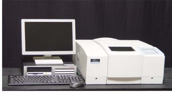
Şekil 2.2: Perkin Elmer BX-2 marka FTIR spektrofotometresi.
