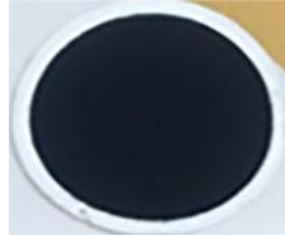
Şekil 2.1: Vakum filtrasyonu ile elde edilen PANI-KNT %1 kompozit disk örneği.
