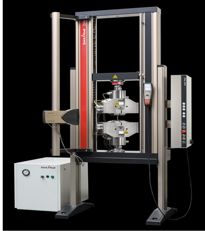
Şekil 2.11: Çekme testinde kullanılan test makinesi.
