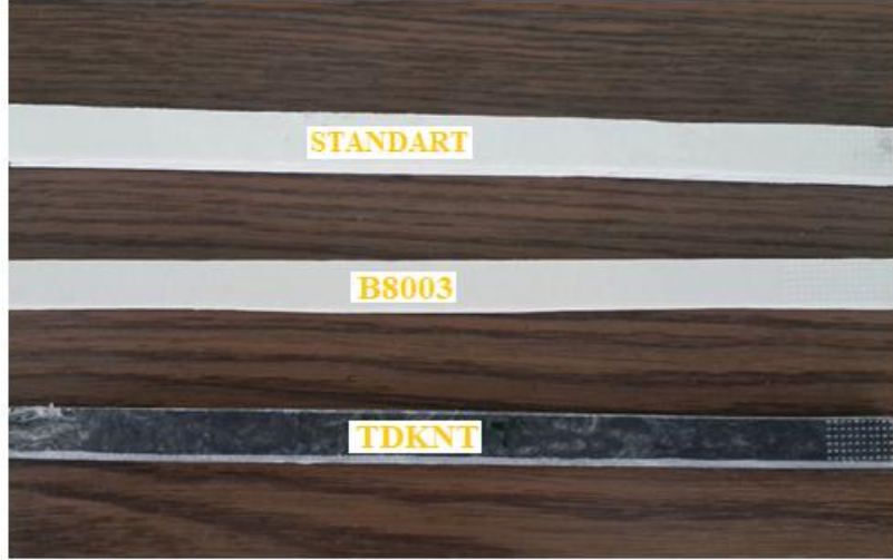
Şekil 2.10: Çekme testinde kullanılan kompozit çubuklar.
