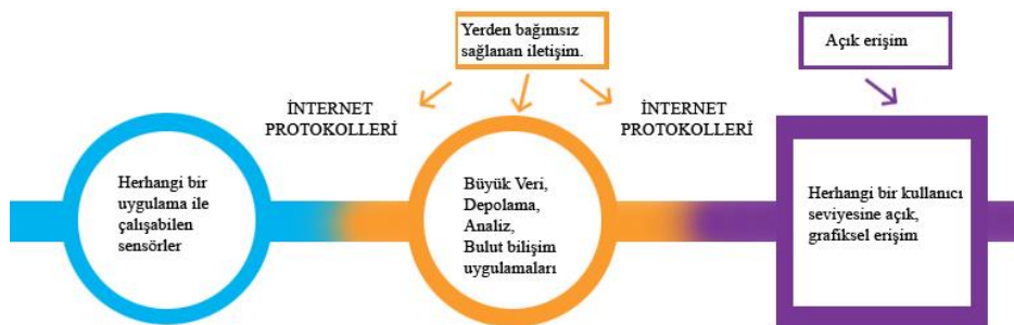
Şekil 4.17: Üretim sektörü IIoT tabanlı SCADA yapısı.
