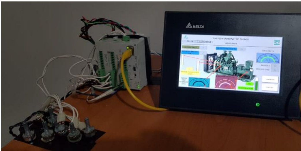
Şekil 5.9: PLC’den ölçümlerin alınması ve görüntülenmesi yapısı.
