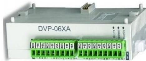
Şekil 3.12: Analog veri ölçümleme modülü.
