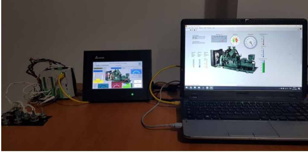
Şekil 5.11: OPC destekli IIoT uygulaması.
