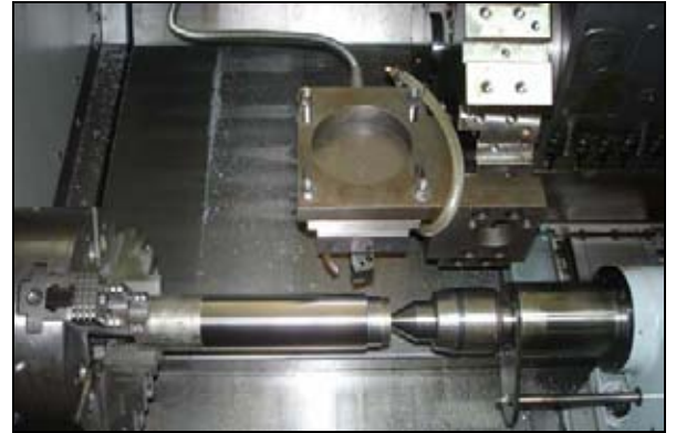
Şekil 2. Dinamometrenin CNC torna tezgahına bağlanması
