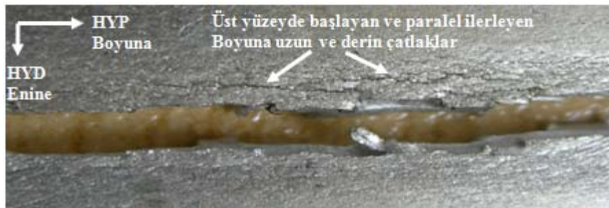
Şekil 5. HYD numune üst yüzeyinde boyuna ilerleyen makro-çatlaklar (büyütme=50X) (The macro-cracks growing longitudinal on the upper surface of the RTD sample (magnification=50X))
