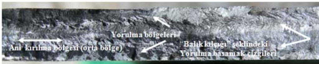
Şekil 4. Kalınlık yönündeki (kesit) kırılma yüzeyinin optik görüntüsü (büyütme=50X) (In thickness direction (cross-section) of the optical image of the fracture surface (magnification=50X))
