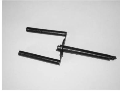
Şekil 1. İki yolluklu plastik enjeksiyon kalıbında basılmış pim numunesi
