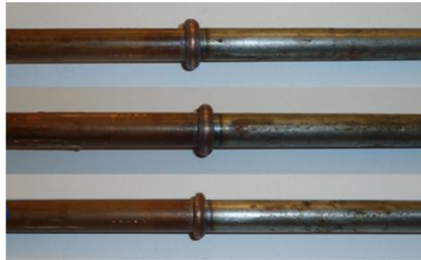
ekil 2. Sürtünme kayna ı ile kaynaklanmı bakır-AISI 1040 çeli inin görüntüsü
