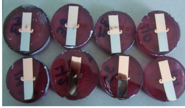
ekil 5. Sertlik ölçümü ve mikro yapı incelemesi için bakalite alınımı kaynaklı numuneler
