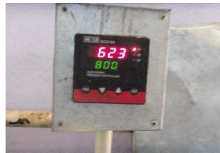
ekil 3. Isıl i lem fırını kontrol ünitesi
