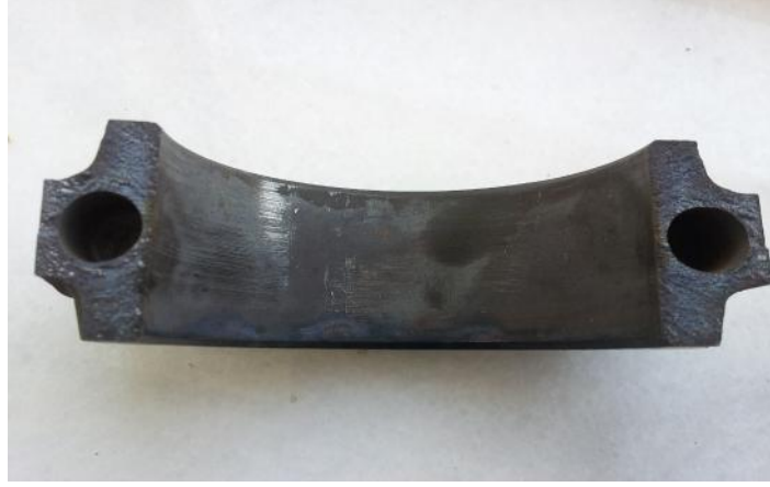
ekil 13. Darbeli kırma deneyinden sonraki kusursuz gevrek kırılma yüzeyi
