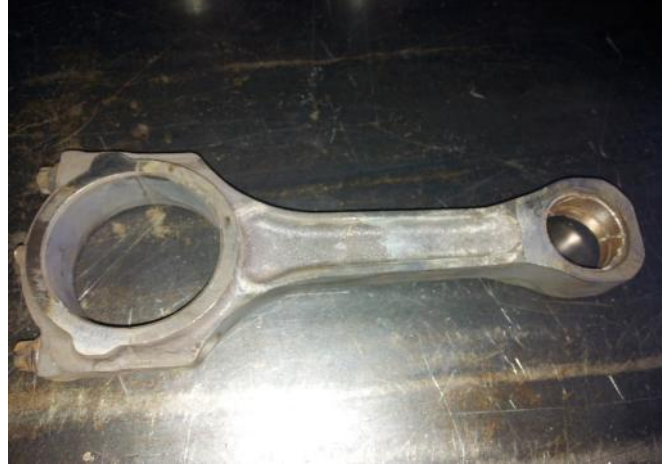
ekil 4. Deneyleerde kullandı ımız temperlenmi martenzitik C70S6 çeli i
