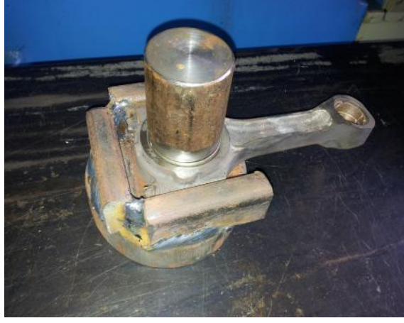
ekil 10. Kırılma testinden önce C70S6 biyel kolu ve oturma kalıbı
