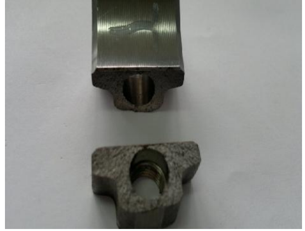
Resim 3.5 Kırılma sonrası yüzeyler (b) [5]
