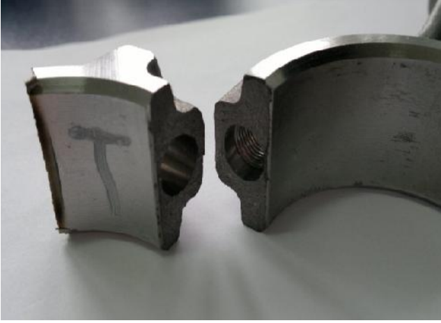
Resim 3.5 C70S6 Kırılma sonrası yüzeyler (a) [5]
