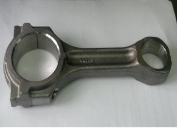
Resim 3.1 C70S6 kırılabilir biyel kolu [6]
