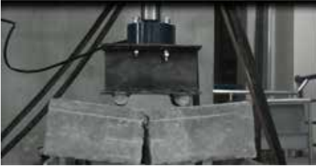
Şekil 5. Lifli beton numunenin deney sonrası kırılma davranışı.
