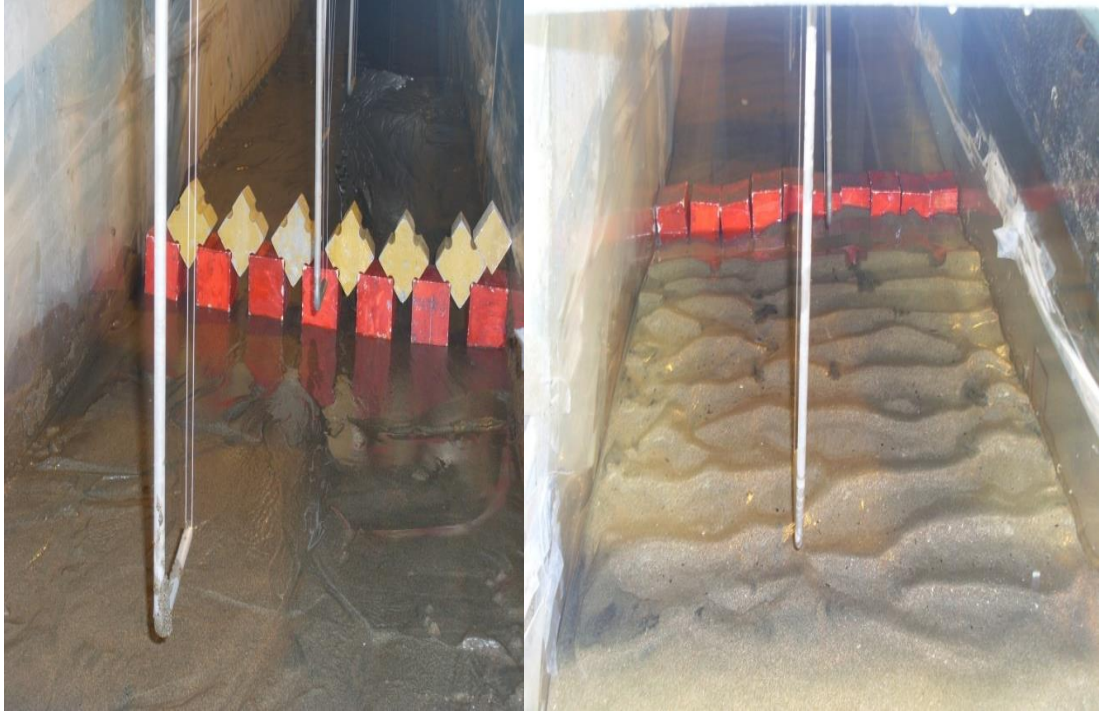
Şekil 3.7 ve 3.8 Deneyleerde kullanılan dolu ve çift sıra antifer bloklı resifler
