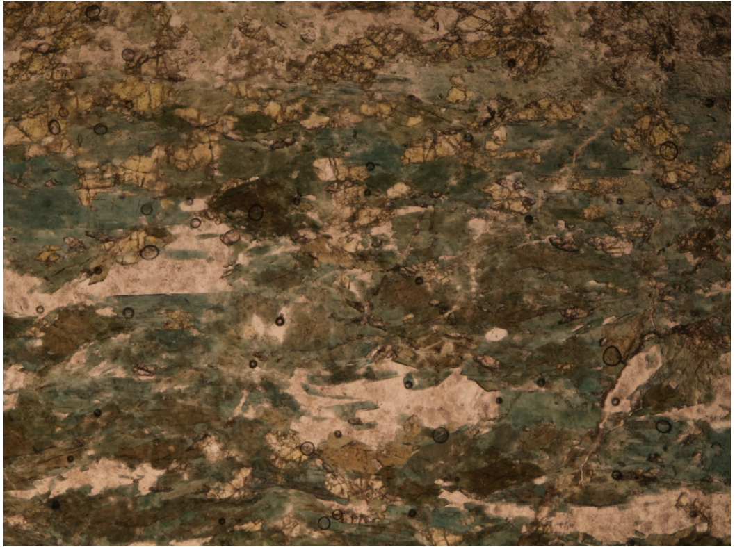
Şekil 5.8: Ofiyolit tabanı amfibolitlerinin mikroskop görüntüleri: Plajiyoklas epidot hornblend şist (I.nikol 4x) (Görüntü Boyutu: 2mm)
