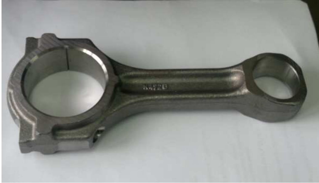
Resim 2.1: C70S6 kırılabilir biyel kolu
