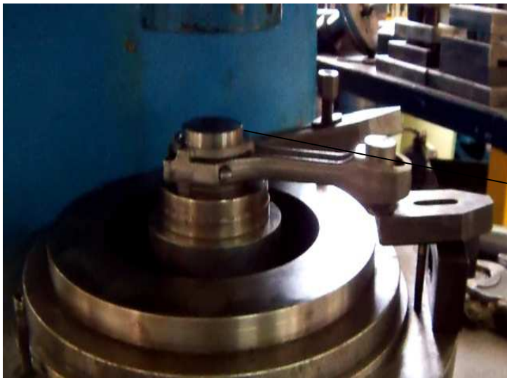
Resim 2.3: Kırarak ayırma deney aparatı ve kırıcı uç
