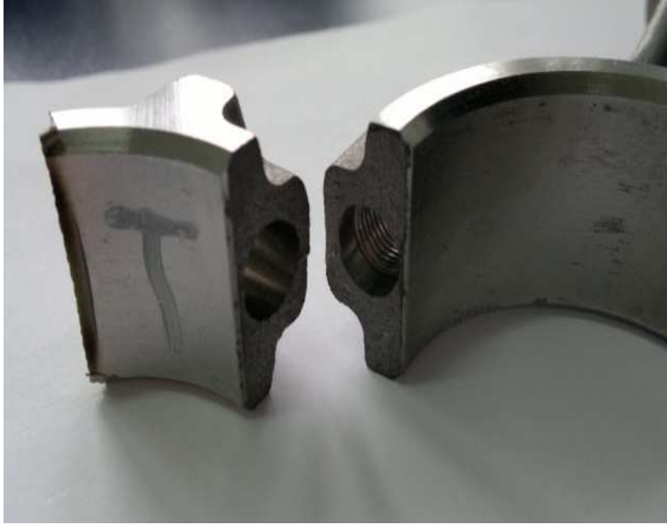
Resim 2.4: C70S6 kırılma sonrası yüzeyler
