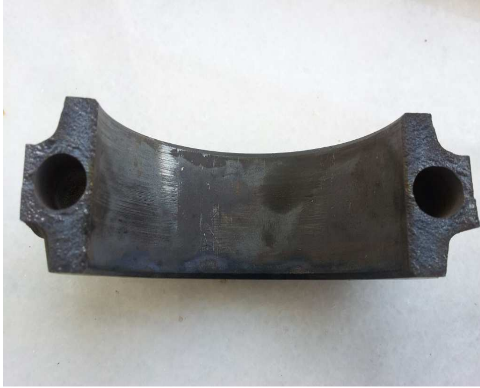
Resim 3.29: Temperlenmiş martenzit C70S6 kırılma yüzeyi
