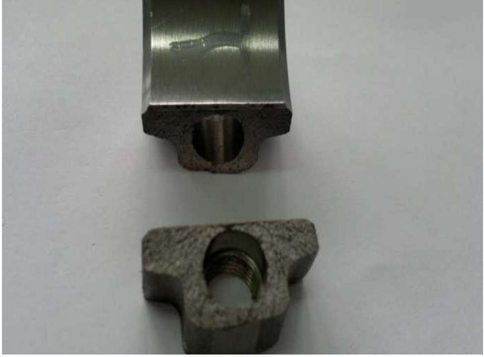
Resim 3.27: C70S6 kırılma yüzeyi
