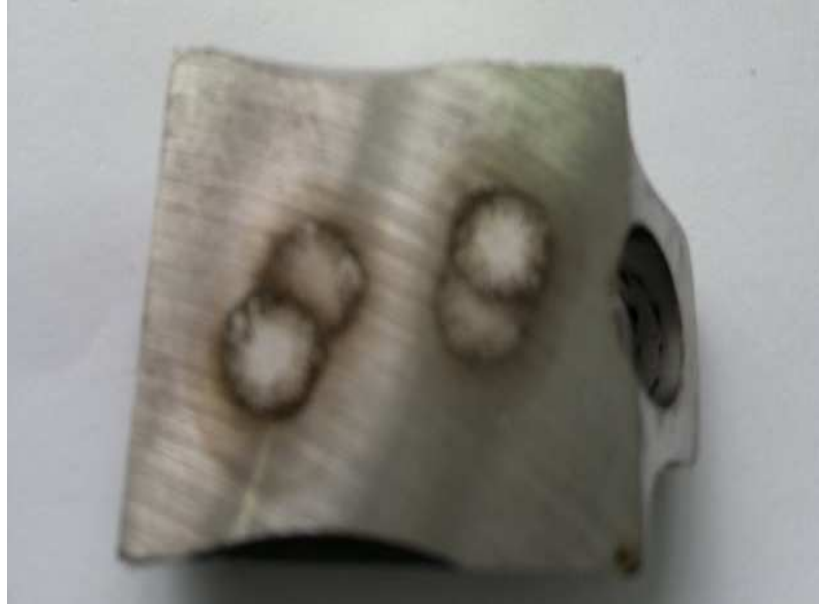
Resim 2.6: C70S6 Biyel kolu sertlik analizinde kullanılan yüzey
