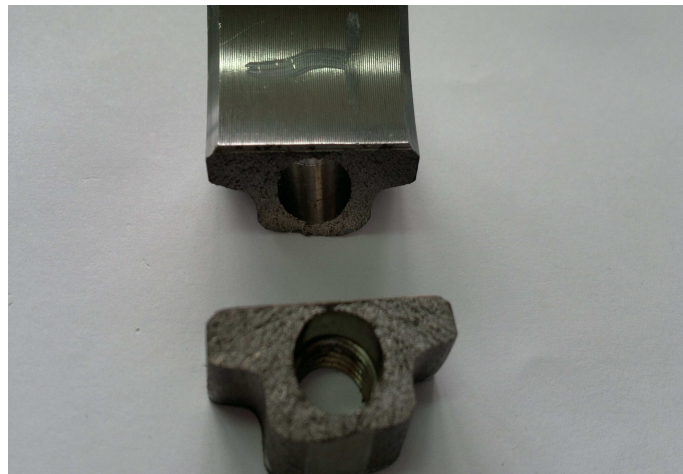
Resim 2.8: Gevrek ve Klevaj Kırılma Yüzeyi
