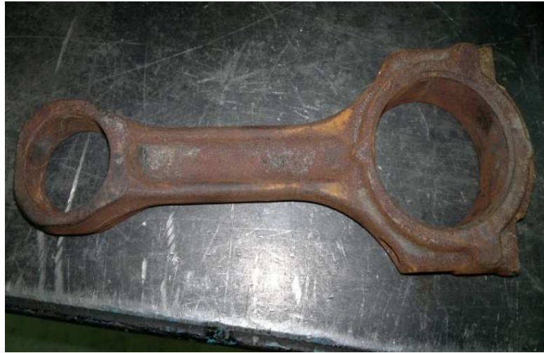
Resim 2.35: % 10 luk NaCl'li Suda Su Verilen C70S6 Çeliğinin Gevrek Kırılması
