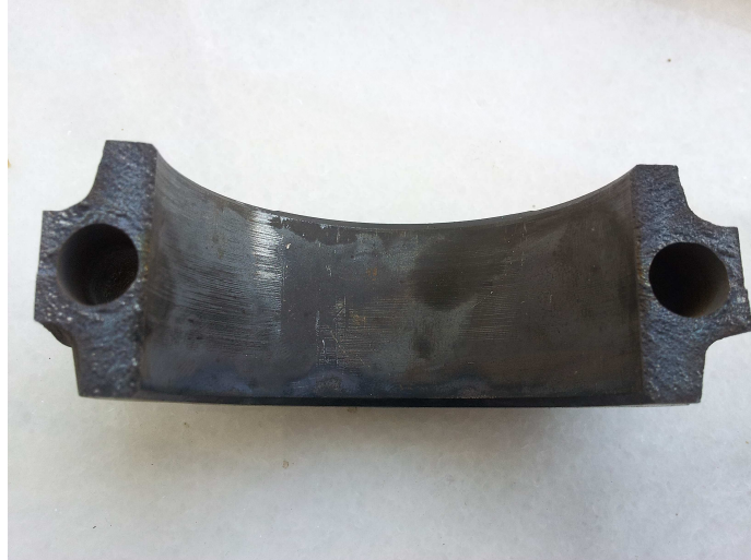
Resim 2.42: Kırma Testinden Sonraki Temperlenmiş C70S6 Çeliği Kırılma Yüzeyi
