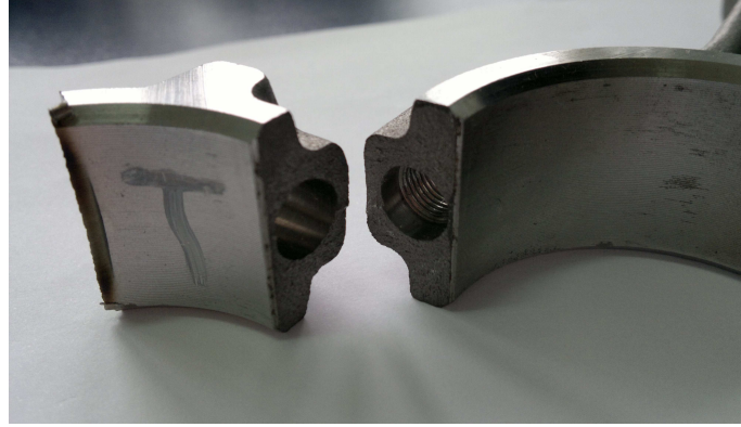
Resim 2.7: Kırılmış ve SEM-Optik Analiz İçin İkiye Kesilmiş Parçalar
