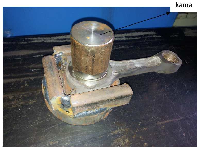
Resim 2.48: C70S6 Biyel Kolu ve Kırma Aparatı
