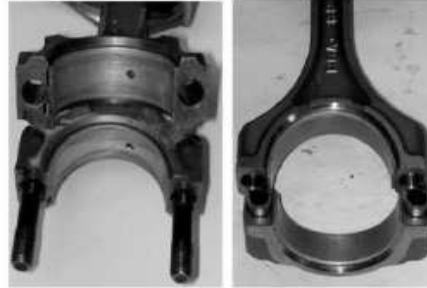
(a) Talaşlı İmalat ile İkiye Ayırma Yöntemi
