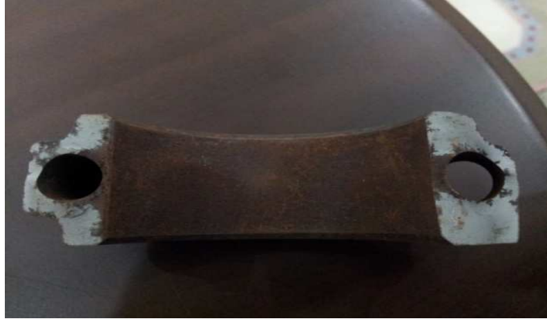
Resim 2.36: % 10 NaCl'li Suda Su Verilen C70S6 Çeliği - Kırma Testi Sonrası
