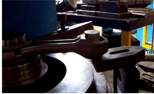
Resim 2.5: Darbeli Presin Altına Yerleştirilen Biyel ve Hazırlanan Kırma Tertibatı
