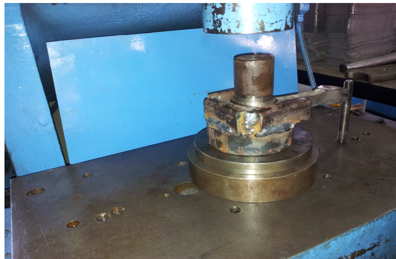
Resim 2.49: Kırma Test Aparatı ve Sabitleme Mekanizması
