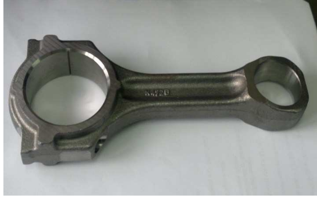
Resim 2.1: Kırma Deneyinde Kullanılan C70S6 Biyel Kolu
