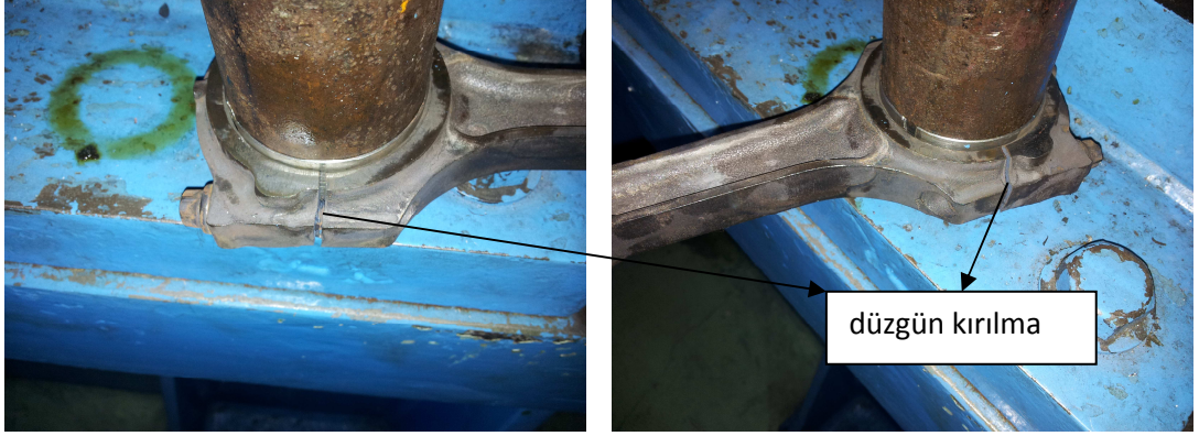
Resim 2.52: Kırma Testi Sonrası Temperlenmiş Martenzitik Yapıdaki C70S6
