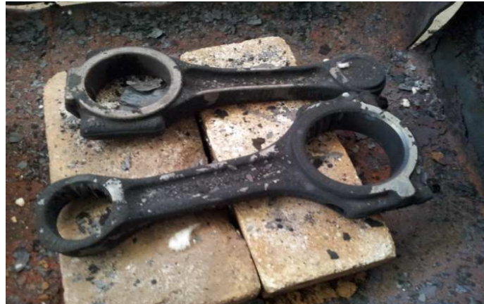
Resim 2.24: Östenitleme Sıcaklığına Çıkartılıp Havada Su Verilen C70S6
