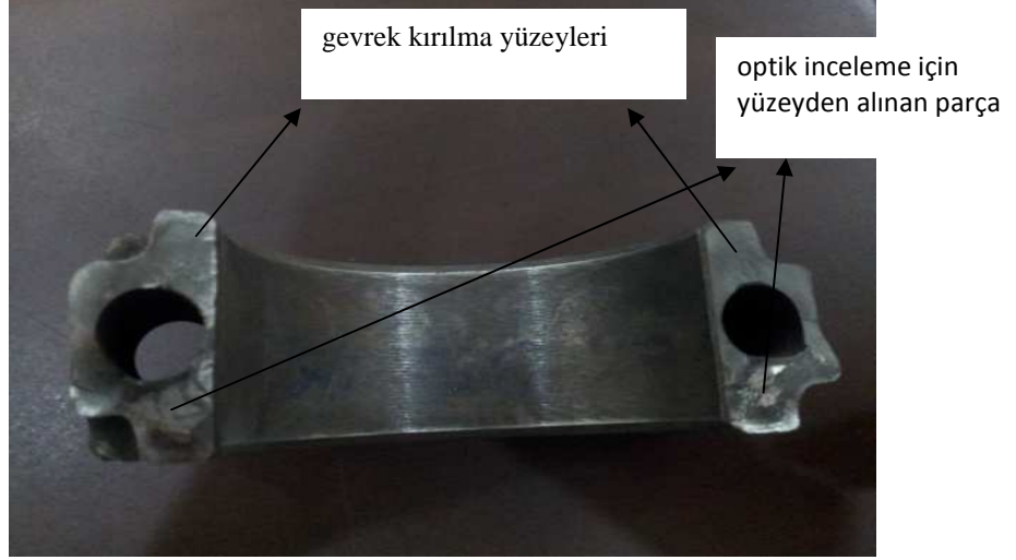
Resim 2.34: Suda Su Verilen C70S6 Çeliğinin Gevrek Kırılması
