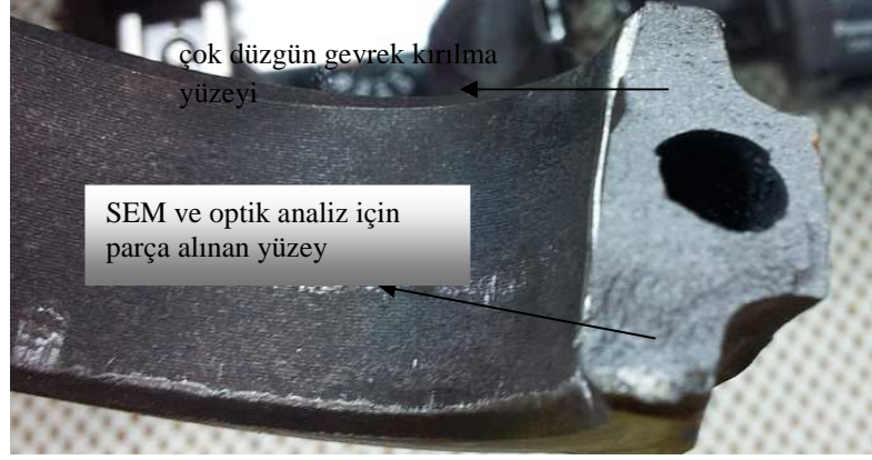
Resim 2.56: Östempirlemeden Sonra Kırma Testi Yapılan C70S6 - 1
