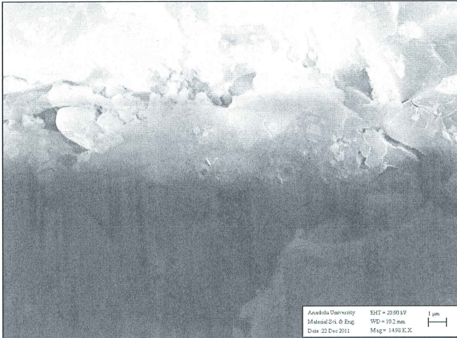
Şekil 4.13: Cu-porselen 9 nolu difüzyon numunesindeki bağlantı bölgesinin ikincil elektron incelemesi ile mikroyapı görüntüsü
