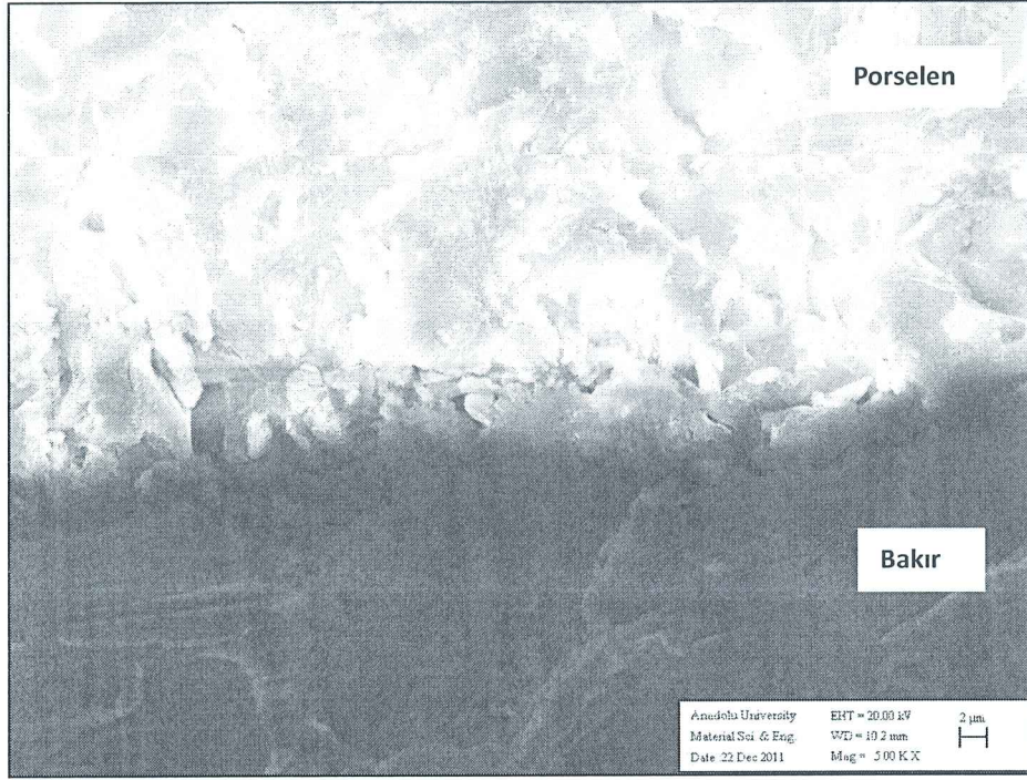
Şekil 4.12: Cu-porselen 9 nolu difüzyon numunesindeki bağlantı bölgesinin ikincil elektron incelemesi ile mikroyapı görüntüsü
