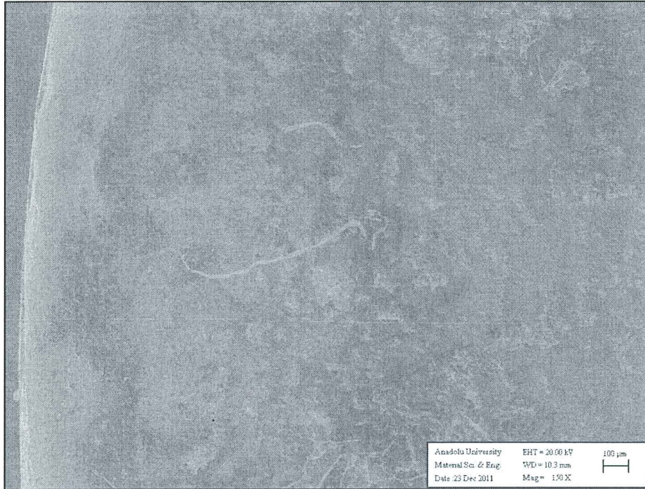
Şekil 4.15: 11 nolu Cu-porselen difüzyon numunesindeki Cu numunenin kırılma yüzeyinin ikincil elektron incelemesi ile mikroyapı görüntüsü
