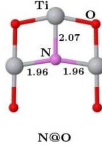
Şekil 3.4: TiO 2 anataz örgüsü içerisindeki tek N dopantının optimize olmuş yapısı. Uzunlukların birimi angstromdur.
