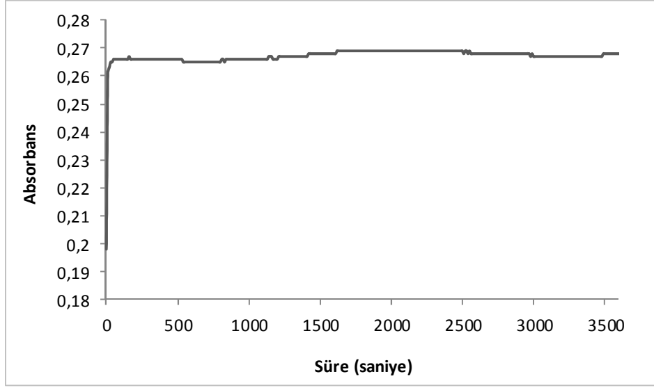
Şekil 3.51: FeBSHP kompleksinin absorbansının zamana bağlı değişimi ( \lambda = 240 \text{ nm} , \text{pH}=4 , 25 \text{ }^\circ\text{C} )
