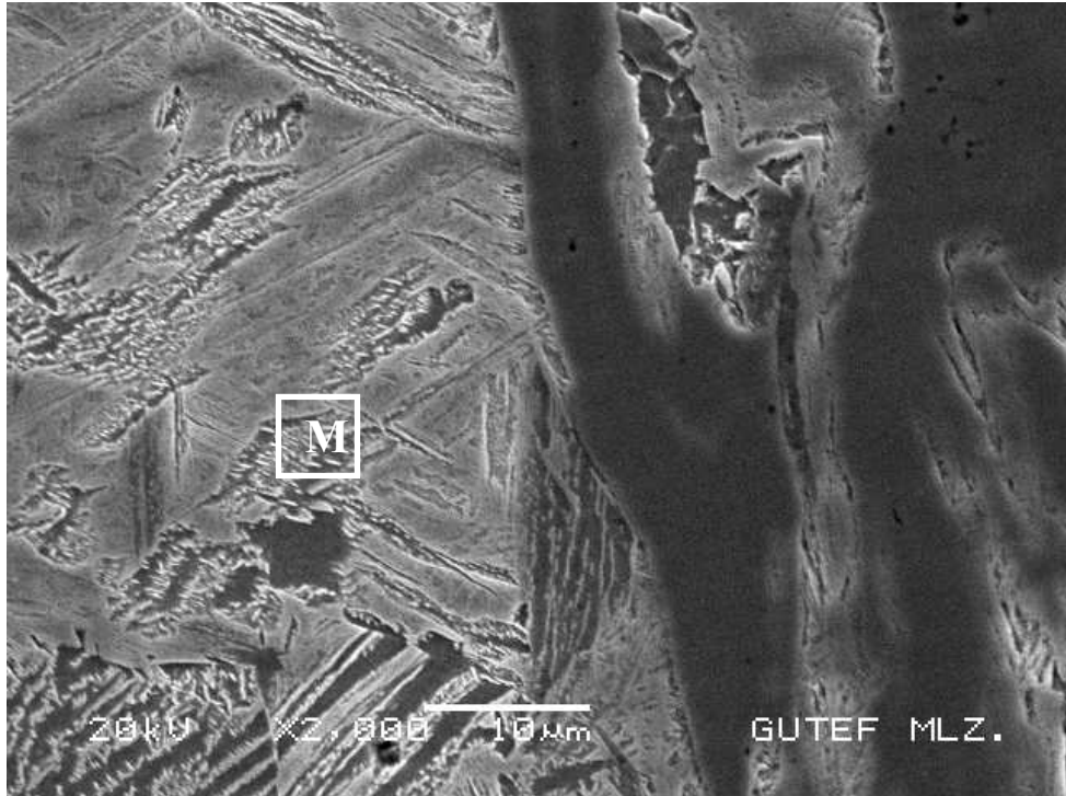
Şekil 3.47 Numune 9 Ck 45 çeliği ITAB 4 ve kaynak ara yüzeyi SEM görüntüsü
