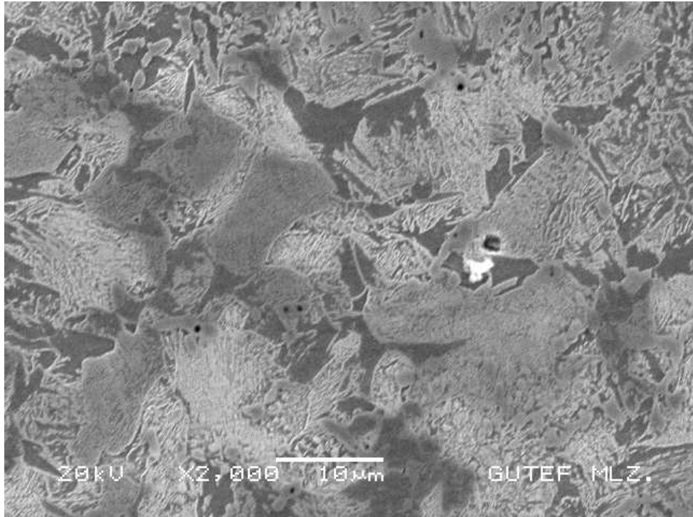
Şekil 3.45 Numune 9 Ck 45 çeliği ITAB 2 SEM görüntüsü
