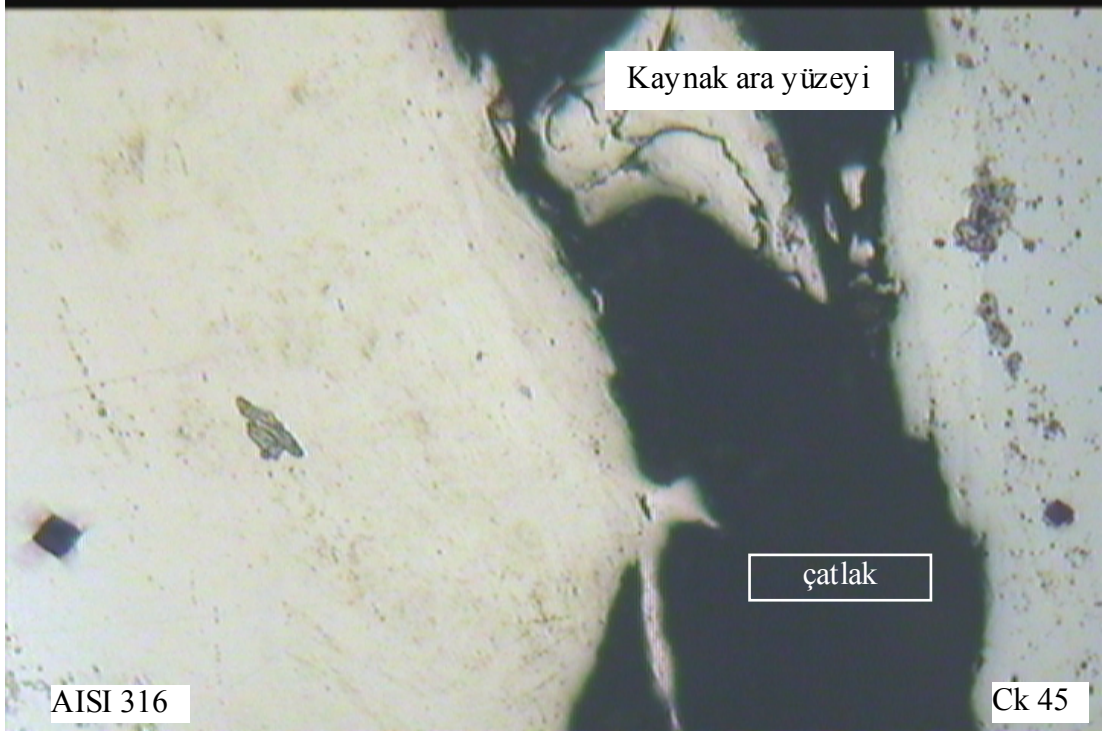
Şekil 3.15 Numune 11 sertlik ölçüm izleri ve çatlak yeri
