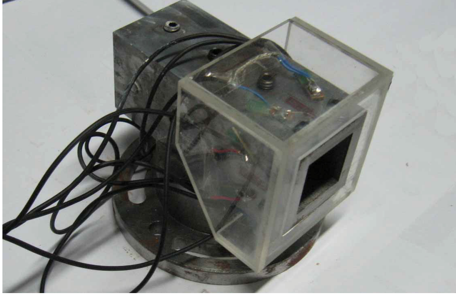
Şekil 3.18 Uzama ölçerli ve muhafazalı dinamometre
