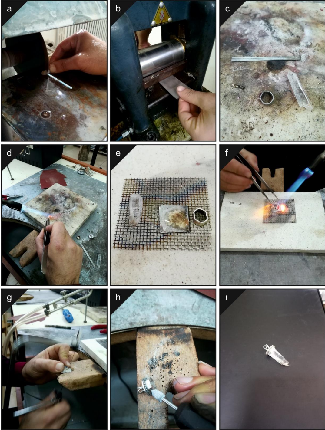
Şekil 11.5: Şaphane Dağı şeffaf kuvars kristallerinde kristalin taban kesimine metal yerleştirme ile takı tasarımı amacıyla yapılan işlemler a) süstaşının kesme makinasında taban kısmının kesilmesi, b) Takıya uyarlanacak metalin hazırlanması işlemi, c) Kuvars kristali boyutuna göre metalin şekillendirilmesi, d) Şekillendirilen metalin uçlarının şaloma yardımıyla birleştirilmesi, e) Hazırlanan metal çerçevenin alt taban kısmının hazırlanması işlemi, f) Metal çerçevenin taban plakaya kaynatılması işlemi, g) Taban plakasının fazlalıklarının testere yardımıyla kesilmesi, h) Kristale uyarlanan takının freze motoru kullanılarak temizliğinin yapılması ve parlatılması, ı) Takının son hali.
