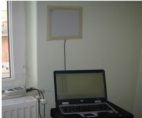
Şekil 2.11 Isı akış plakası ile dış duvar ısı transfer katsayısı ölçümü.
