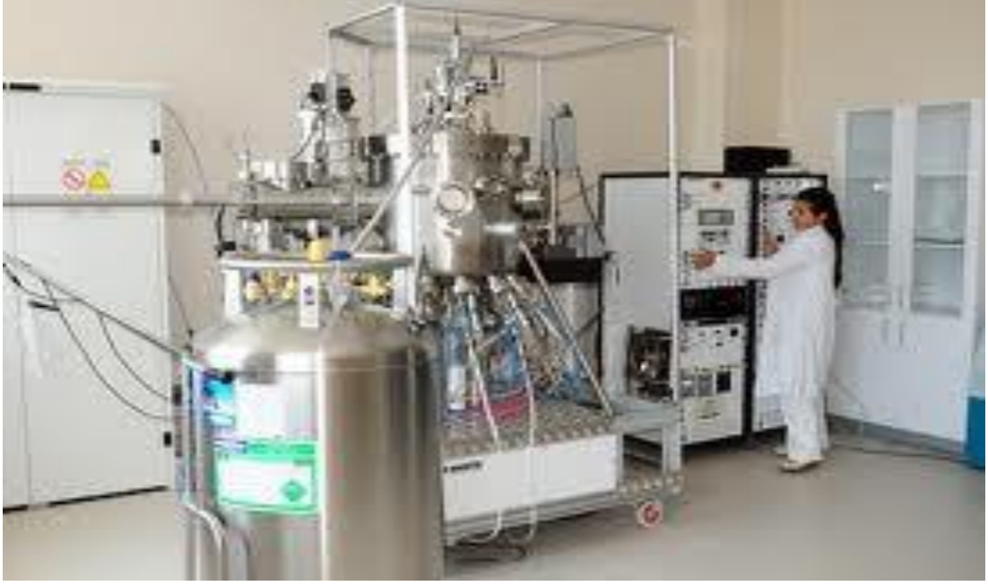
Şekil 2.4: Epitaksiyel büyüme tekniğinde kullanılan cihaz.
