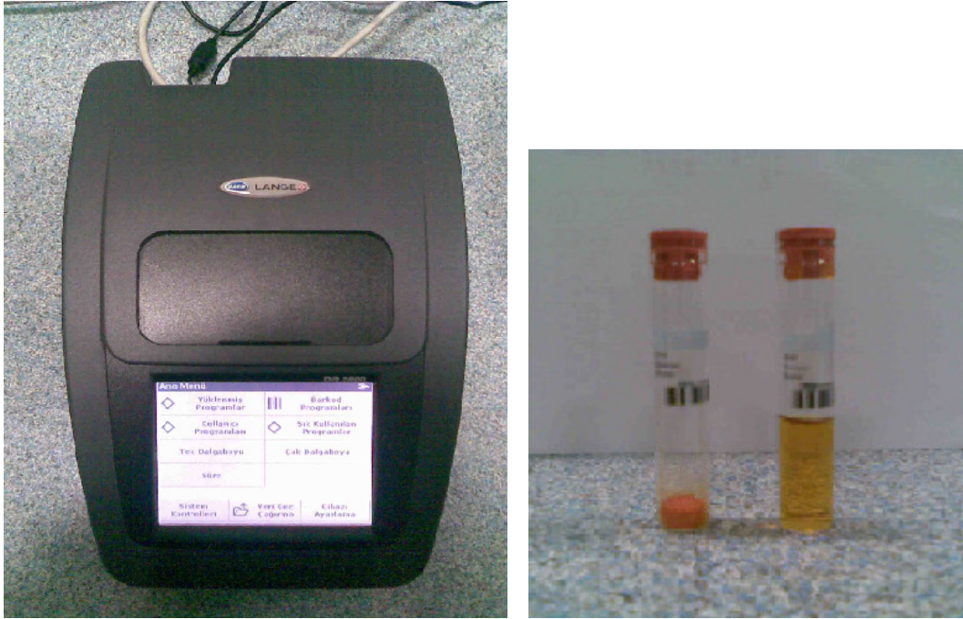
Şekil 2.3 HACH Lange DR2800 marka spektrofotometre ve Lange LCK 307 bor kiti
