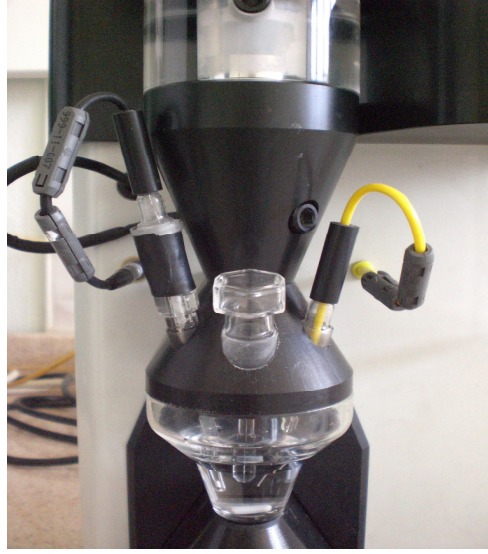
Şekil 2.2 Üçlü elektrot sistemi ve voltammetrik hücre
