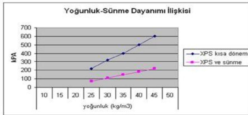
Şekil 2.6: XPS' e ait yoğunluk – sünme dayanımı ilişkisi (Sünme: Sabit yük altında uzun süreli deformasyon)
