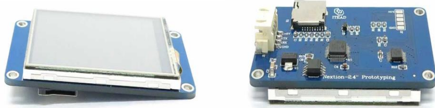
Şekil 2.6: Nextion firmasına ait akıllı ekranın ön ve arka yüzey görüntüsü [24].
