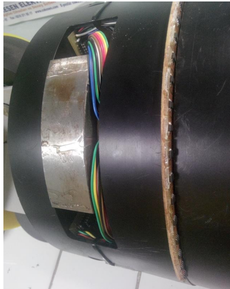
Şekil 2.38: PIG üzerine monte edilen sinyal yükseltme devresi.
