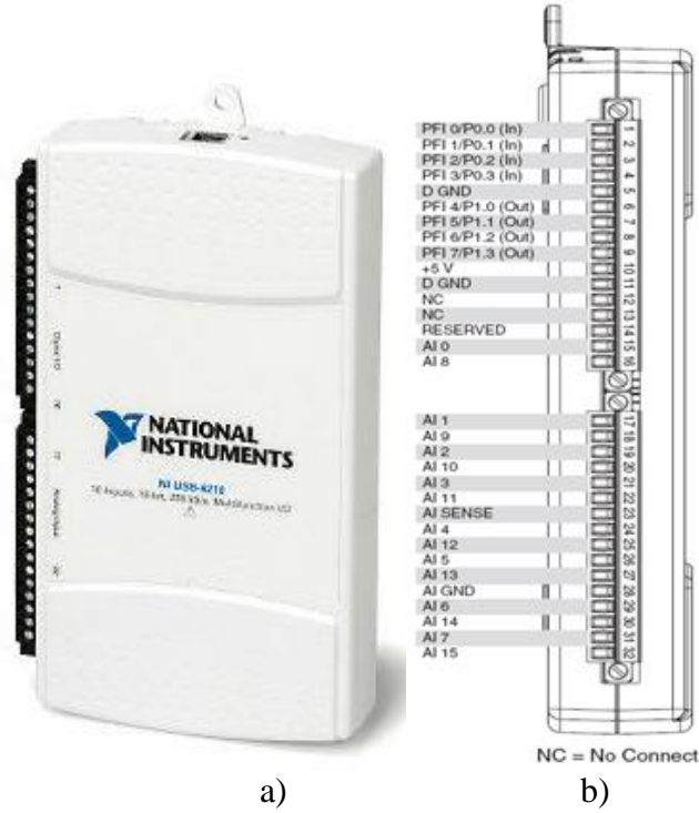
Şekil 2.24: a) NI-USB 6210 b) bağlantı şeması.
