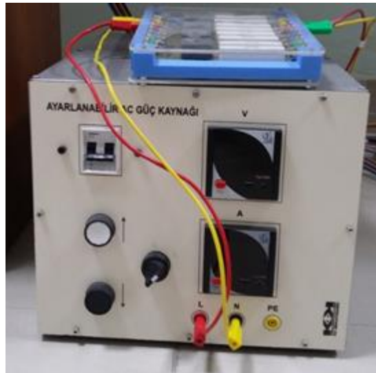
Şekil 2.23: Varyak, doğrultma devresi ve PIG ile bağlantısı.
