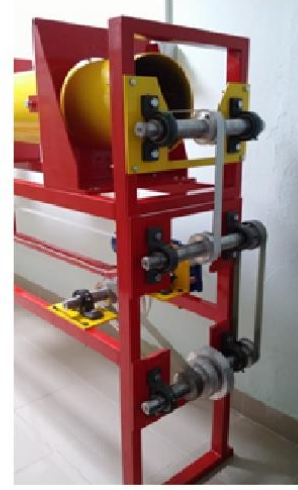
Şekil 2.8: T10 tipi kayış ve sistemde kullanıldığı bölümler.
