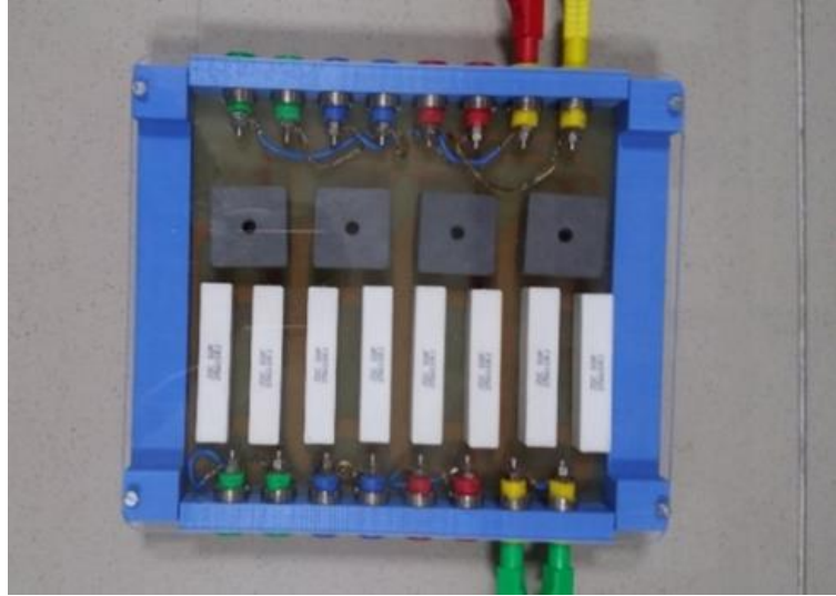
Şekil 2.33: Sistemde kullanılan doğrultma devresi.
