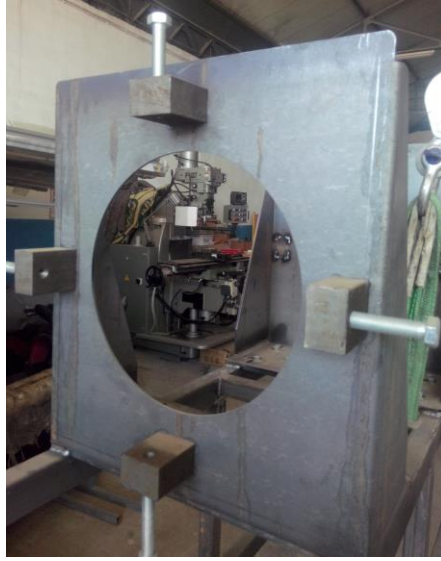
Şekil 2.4: Üretim aşamasında sabitleme levhası.
