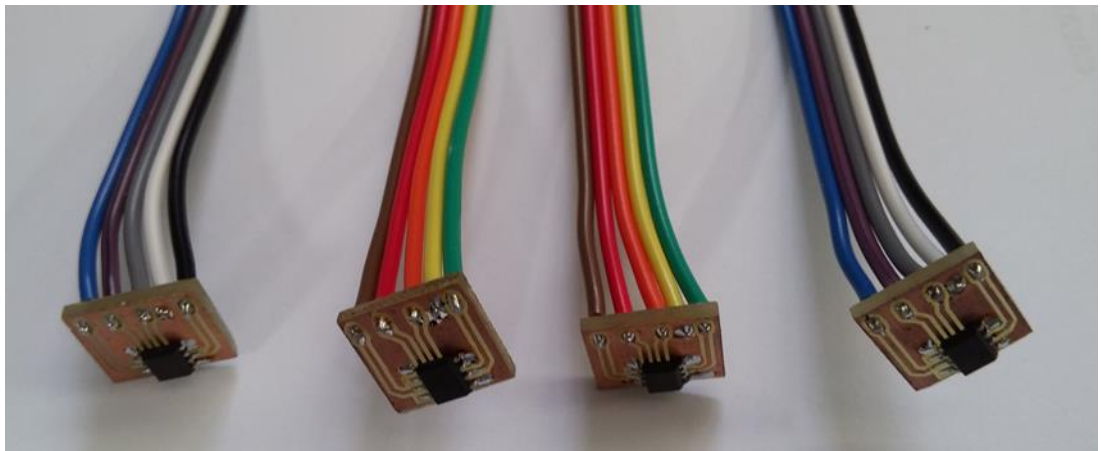
Şekil A.5: Kablo bağlantıları tamamlanan sensör kartları.
