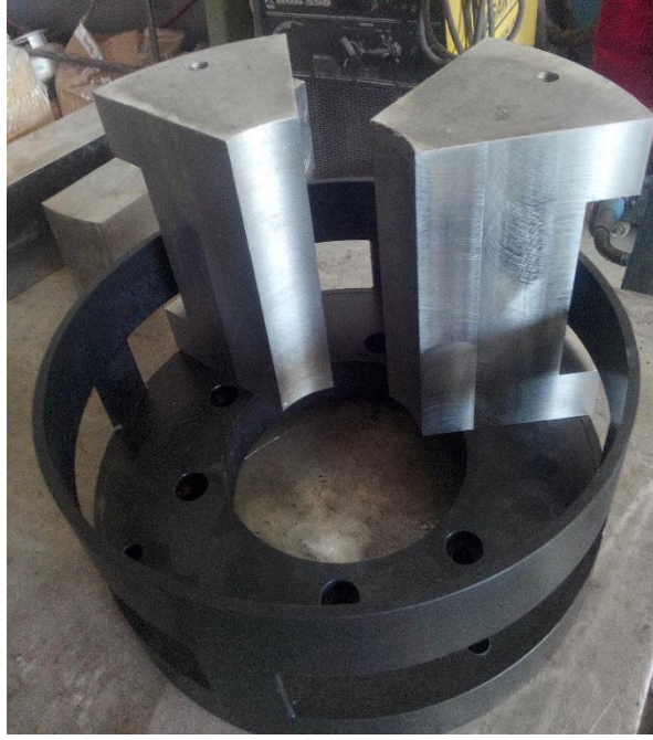
Şekil A.3: Nüvelerin montajı.
