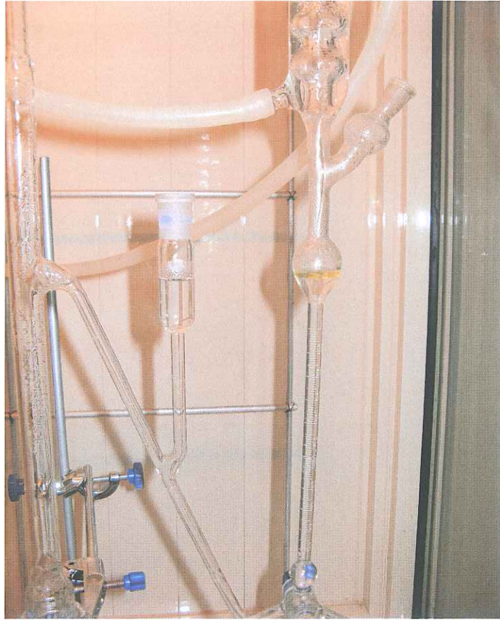
Şekil 2.7 Clevenger cihazının toplama ünitesinde biriken uçucu yağ
