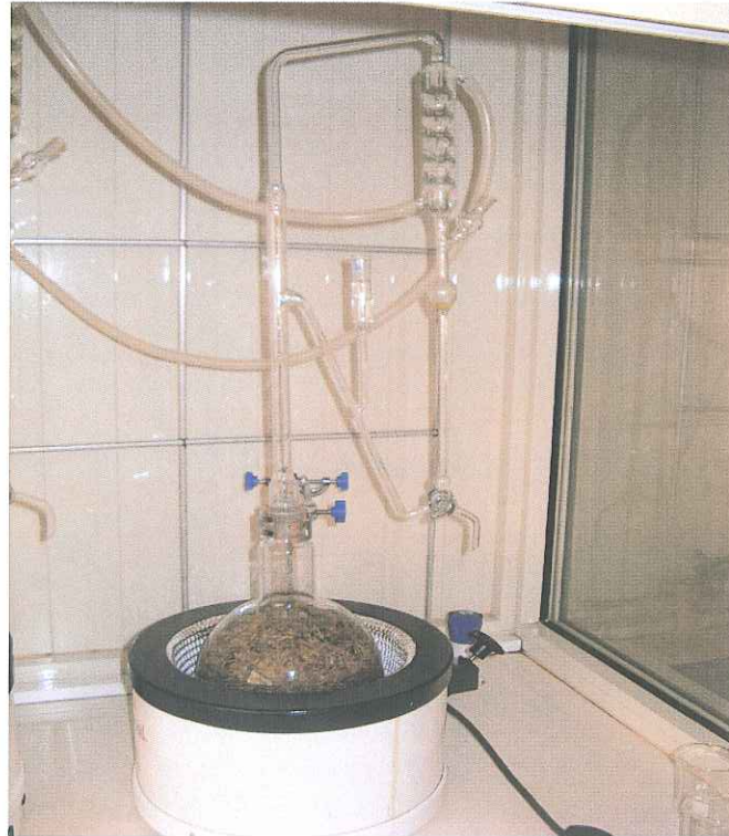
Şekil 2.6 Clevenger cihazı ve hidrodistilasyon yöntemiyle bitki örneğinden uçucu yağ elde edilişi
