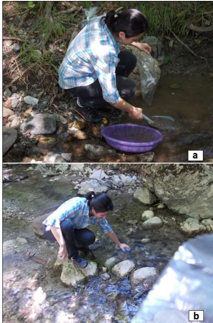
Şekil 1.1: a) Çalışma alanında dere kumu örneklemesinden bir görünüm, b) Çalışma alanında dere suyu örneklemesinden bir görünüm.
