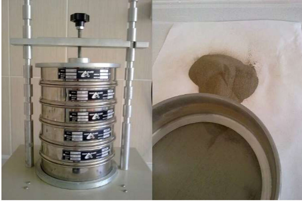
Şekil 1.3: Dere kumu örneklerinin elek analizi yapıışı.
